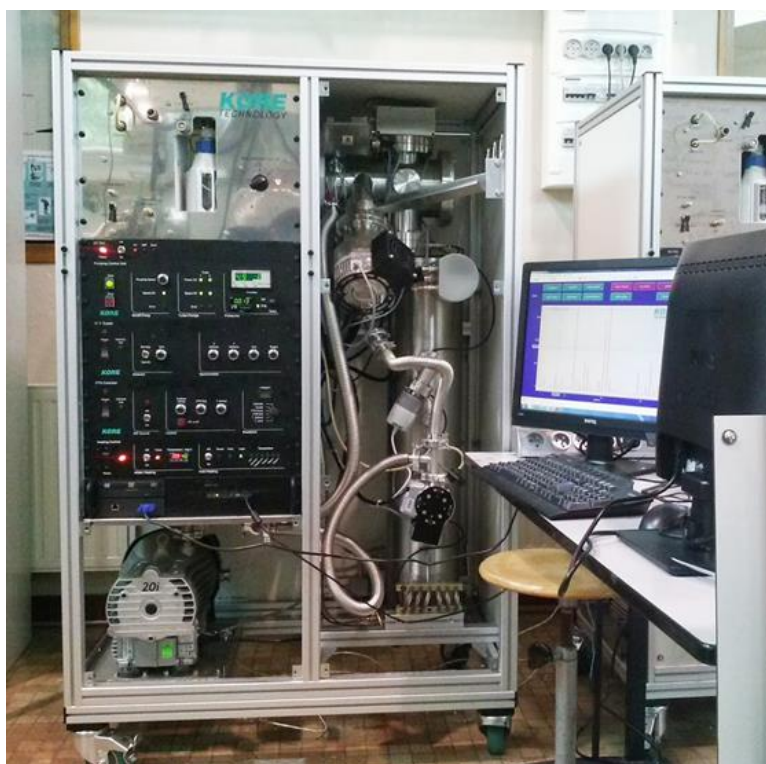
Figure 33. Photographie du PTR-TOF-MS (KORE Technology LTD, série II).
