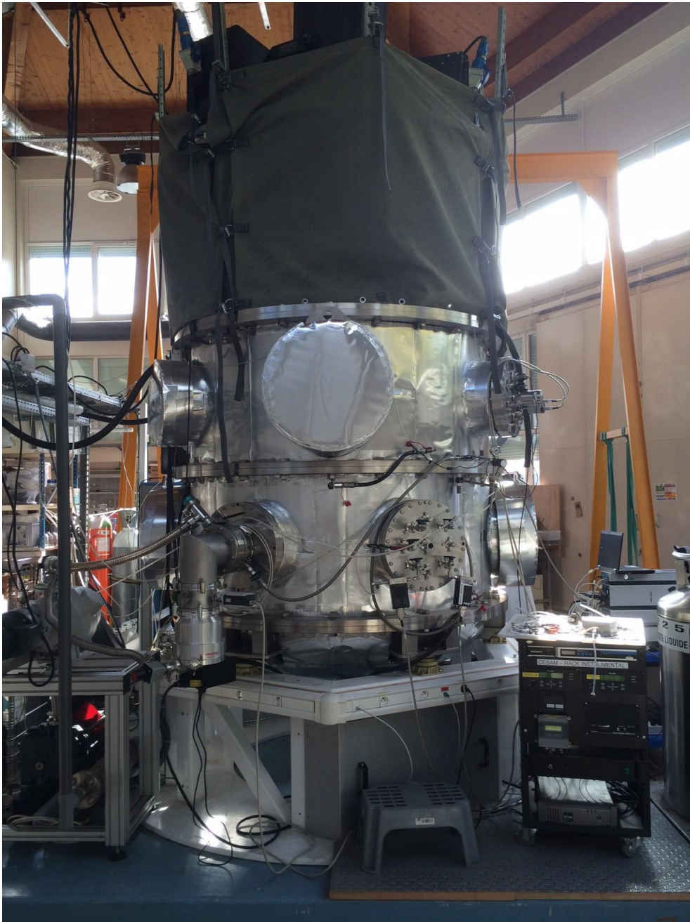
Figure 25. Vue de la Chambre Expérimentale de Simulation Atmosphérique Multiphasique (CESAM) du LISA située à l'Université Paris Est Créteil.
