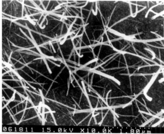
Figure I.18. Image MEB d'une vue transversale d'une croissance de nanofils de ZnO par procédé de pulvérisation cathodique [62].
