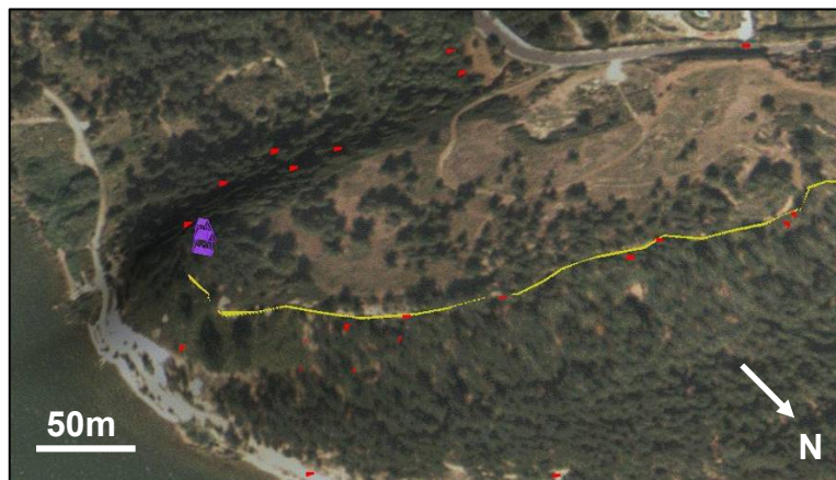
Fig. 1.5 : Exemple d'un contour géologique digitalisé directement sous gOcad et calibré avec des points GPS (points rouges – tous les points ne se rapportent pas au même contour) et la photo aérienne.
