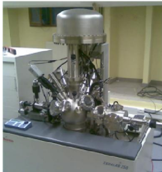
spectrophotomètre XPS Thermo Electron ESCALAB 250 (Institut Charles Gerhardt)
