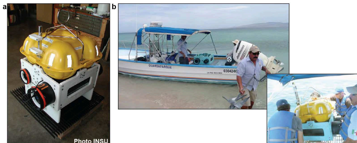
FIGURE 9.4 – (a) Sismomètre fond de mer (OBS) de courte-périodes (SPOBS). (b) Déploiement d'un OBS au large de La Paz (photo R. Daniel).
