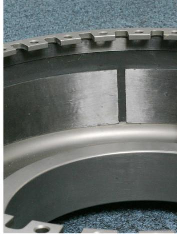
FIGURE 5.22 – Dispositif d’amortissement viscoélastique sur le diamètre intérieur d’un disque aubagé [10]
