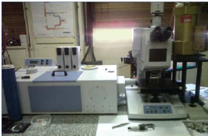
Figure II.2 – a) photo du Bruker TM IFS66v couplé au microscope Bruker TM HYPERION au laboratoire des colloïdes, verres et nanomatériaux (Université de Montpellier) ; b) schéma du chemin des faisceaux optiques de l'HYPERION (d'après la brochure Bruker TM ).
