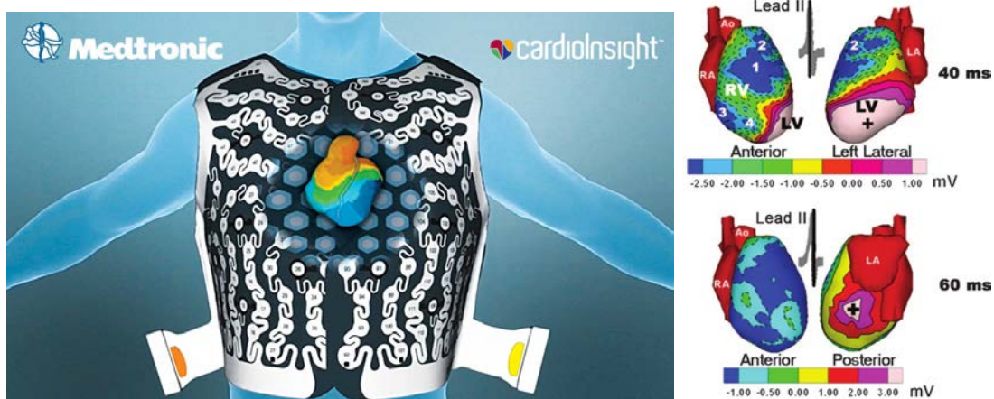
FIGURE 2.13 – Veste ECM (Medtronic CardioInsight ® ) et EGMs. D'après [Ramanathan et al. , 2006]. A partir des mesures des électrodes surfaciques, les EGMs de la surface épiscopardique sont reconstruits et représentés sur le modèle géométrique. Sur la figure de droite, la dépolarisation des ventricules aux abords de l'onde Q de l'ECG est représentée.
