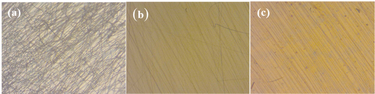
Figure II-18. Images au microscope optique de différentes morphologies des microfibres de PVDF-TrFE : (a) microfibres non alignées, (b) amélioration dans l'alignement et (c) microfibres bien alignées.
