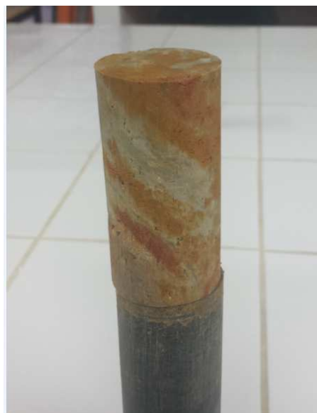
Figure 9. Epreuve triaxiale du sol argileux de Bussy-Saint-Georges
