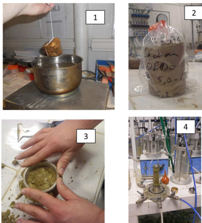
Figure 4.29 Illustrations de la démarche de réalisation des essais de laboratoire. 1 : Détermination de la masse volumique ; 2 : Echantillon prélevé pour l'essai œdométrique ; 3 : Préparation de l'éprouvette pour l'essai œdométrique ; 4 : Mise en place de l'éprouvette triaxiale
