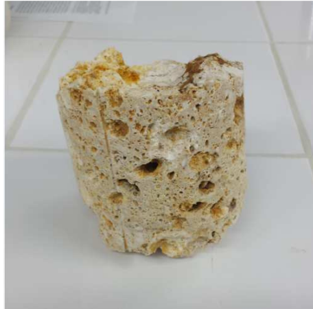
Figure 3.18 Carotte de calcaire retrouvée à l'intérieur de la gaine SC-02
