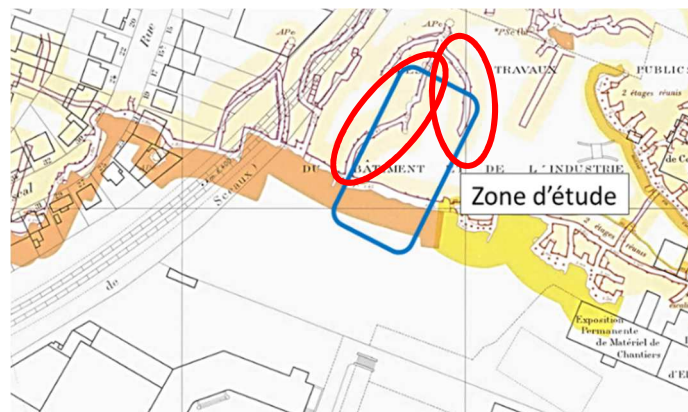
Figure 4.2 Indication de la zone d'étude (en bleu) et prolongement des carrières souterraines (entourées en rouge) dans l'extrait de la carte des carrières n°24-61 (Atlas des carrières souterraines de Paris, des Hauts-de-Seine, de Seine-Saint-Denis et du Val-de-Marne de l'Inspection Générale des Carrières, IGC)
