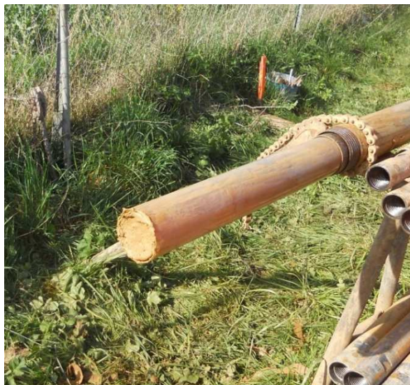
Figure 6. Extraction de l'étui en PVC contenant l'échantillon intact
