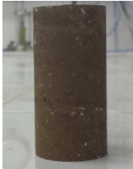
Figure 4.34 Eprouvette triaxiale reconstituée en laboratoire
