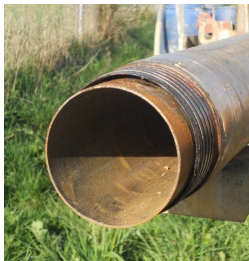
Figure 3. Carottier double (tube extérieur rotatif et tube intérieur libre)
