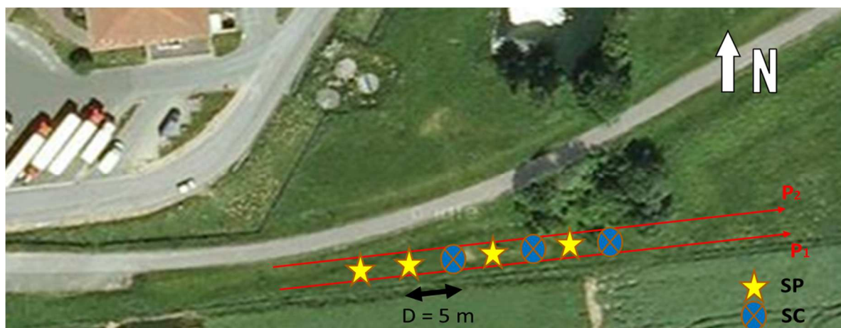
Figure 1. Implantation des sondages carottés (SC) ensemble avec les sondages pressiométriques (SP) le long des profils sismiques P1 et P2
