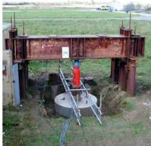
Figure 3.35 Vue d'ensemble de l'essai de chargement sur la fondation mixte à Merville (Coquillay, 2005)
