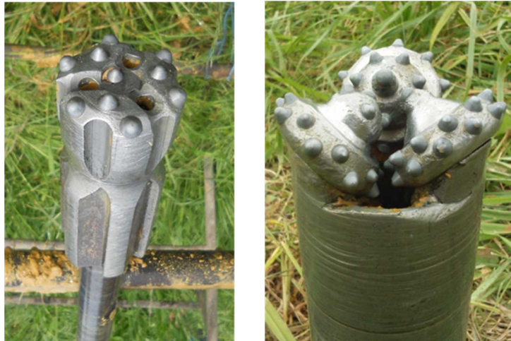
Figure 3.13 Outils de forage (taillant à boutons et tricône)
