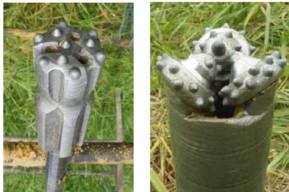
Figure 54. Outils de forage (taillant à bouton et tricône)
