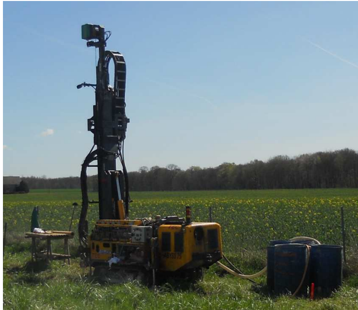
Figure 2. Positionnement sur le terrain de la sondeuse utilisée pour le prélèvement de sol par carottage triple
