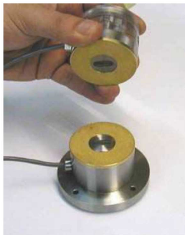
Figure 38. Eléments piézo-électriques (Lopez-Caballero, 2010)
