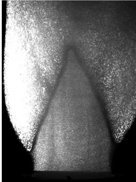
FIGURE 4.33 – Image de tomographie par plan laser d'une flamme d'aluminium-air.
