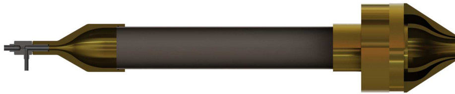
FIGURE 4.21 – Schéma du deuxième prototype de brûleur (prototype 2).
