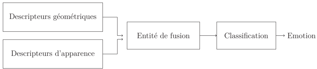
FIGURE 2.14 – Schéma de fusion en amont
