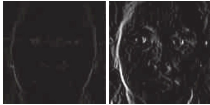
(a) Résultat de la différence de colonne (b) Résultat d'un filtrage par Sobel
