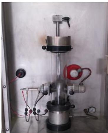
Figure 2.1. Tube de Hartmann modifié de type Mike 3 - Kühner AG - utilisé au LRGP.
