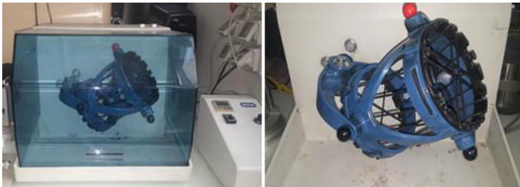
Figure 2.9. Mélangeur chaotique Turbula (T2F - Glen Mills).
