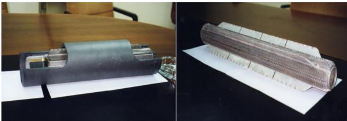
Figure 1.3. a) Chemise de graphite et élément combustible et b) gaine métallique entourant l'élément combustible (source IRSN).
