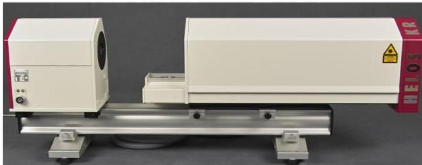
Figure 2.5. Granulomètre à diffraction laser Helos-Vario/KR (Sympatec GmbH).
