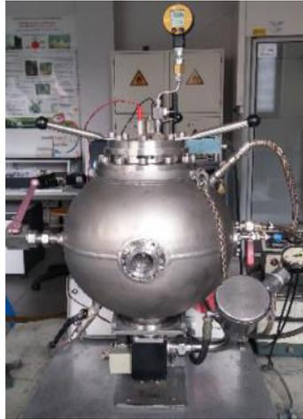
Figure 2.4. Sphère d'explosion de 20 litres.
