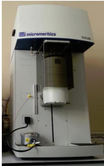
Figure 2.6. Analyseur de caractérisation de surface 3Flex (Micromeritics).
