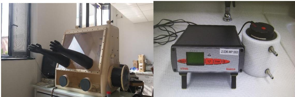
Figure 2.8. a) Boîte à gants et b) Aw-mètre (Rotronic).
