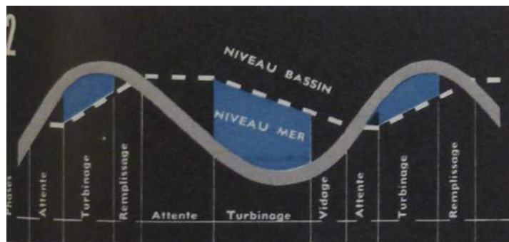
FIGURE 26. Fonctionnement du double effet avec mention du volume des eaux turbinées
