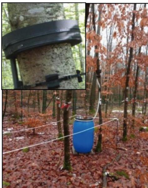
*Figure II-7 : Photo d'un collecteur de ruissèlement de tronc (mousse en polyéthylène + bidon de récupération).
