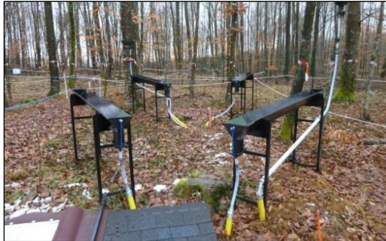
*Figure II-6 : Photo des gouttières permettant l'échantillonnage des pluiolessivats. (Source : Marie Pierre Turpault)*
