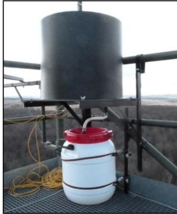
Figure II-5 : Photo d'un collecteur de dépôts atmosphérique (source : Marie Pierre Turpault).
