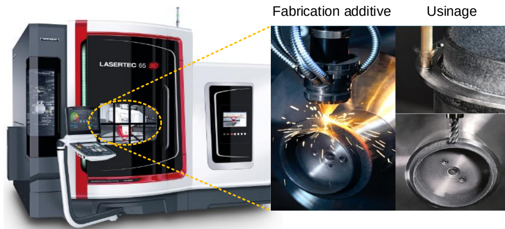
Figure 1.9. Système hybride Lasertec 65 3D développé par DMG MORI 2 .
