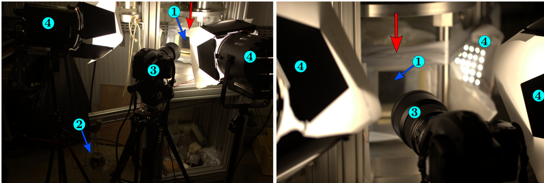
FIGURE 2.1 – Dispositif expérimental pour les expériences de fluage. La flèche rouge représente la direction de la force appliquée sur l'échantillon. (1) Échantillon de glace positionné dans l'enceinte en plastique. (2) Poids positionné sur le bras de levier. (3) Appareil photo (ici un Phase One 80 Mpx ) et son objectif (ici un objectif macro 140 mm ). (4) Éclairages (ici 2 panneaux LED + 2 spots néon).
