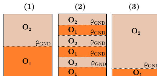
FIGURE 2.17 – Mise en garde pour l'interprétation du GOS . On représente 3 grains avec des sous-structures différentes. O_1 et O_2 sont deux orientations différentes dont l'interface nécessite \rho_{GND} dislocations. Les cas (1) et (2) ont la même valeur du GOS mais une densité de GND différente alors que les cas (1) et (3) ont une valeur différente du GOS mais la même densité de GND .
