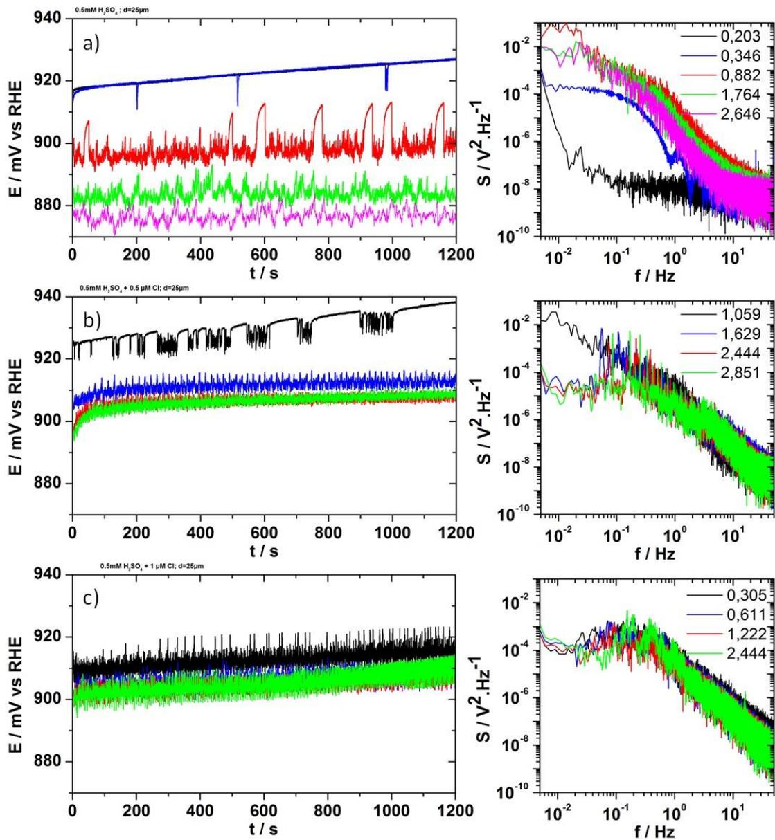
*Annexe 7 : Séries temporelles du potentiel à différents courants appliqués à une microélectrode de 25 µm de diamètre dans un électrolyte de 0,5 mM d'acide sulfurique saturé en CO. a) pour un électrolyte sans chlorures, b) pour un électrolyte avec 0,5 µM de chlorures et c) pour un électrolyte avec 1,0 µM de chlorures. Les figures de droite sont respectivement les spectres de puissance associés aux séries temporelles.*
