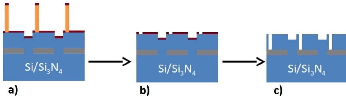
*Figure 21 : a) Dépôt d'une mince couche d'Aluminium de 3 nm d'épaisseur ; b) La résine restante est ôtée par « Lift Off » ; c) Etat de la surface après le procédé de gravure ionique.*
