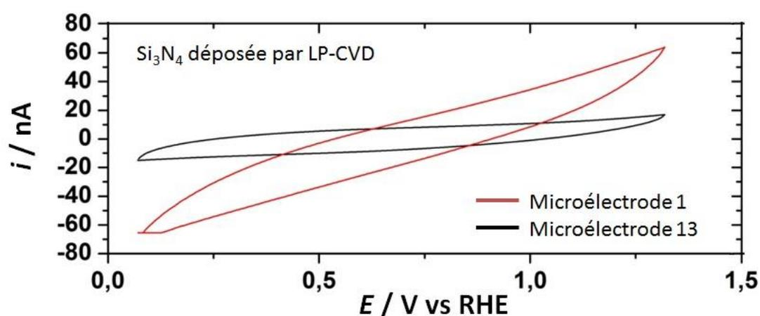
Figure 26 : Cycle voltampérométrie à  $50 \text{ mV.s}^{-1}$  pour une microélectrode d'un réseau de microélectrodes fabriqué à Strasbourg et Munich dans  $\text{H}_2\text{SO}_4$  0,5 mM saturé en  $\text{N}_2$ .
