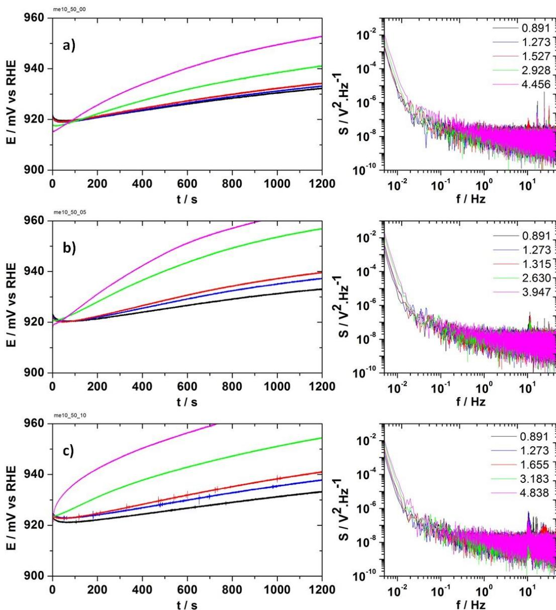
*Annexe 5 : Séries temporelles du potentiel à différents courants appliqués à une microélectrode de 10  $\mu\text{m}$  de diamètre dans un électrolyte de 50 mM d'acide sulfurique saturé en CO. a) pour un électrolyte sans chlorures, b) pour un électrolyte avec 0,5  $\mu\text{M}$  de chlorures et c) pour un électrolyte avec 1,0  $\mu\text{M}$  de chlorures. Les figures de droite sont respectivement les spectres de puissance associés aux séries temporelles.*
