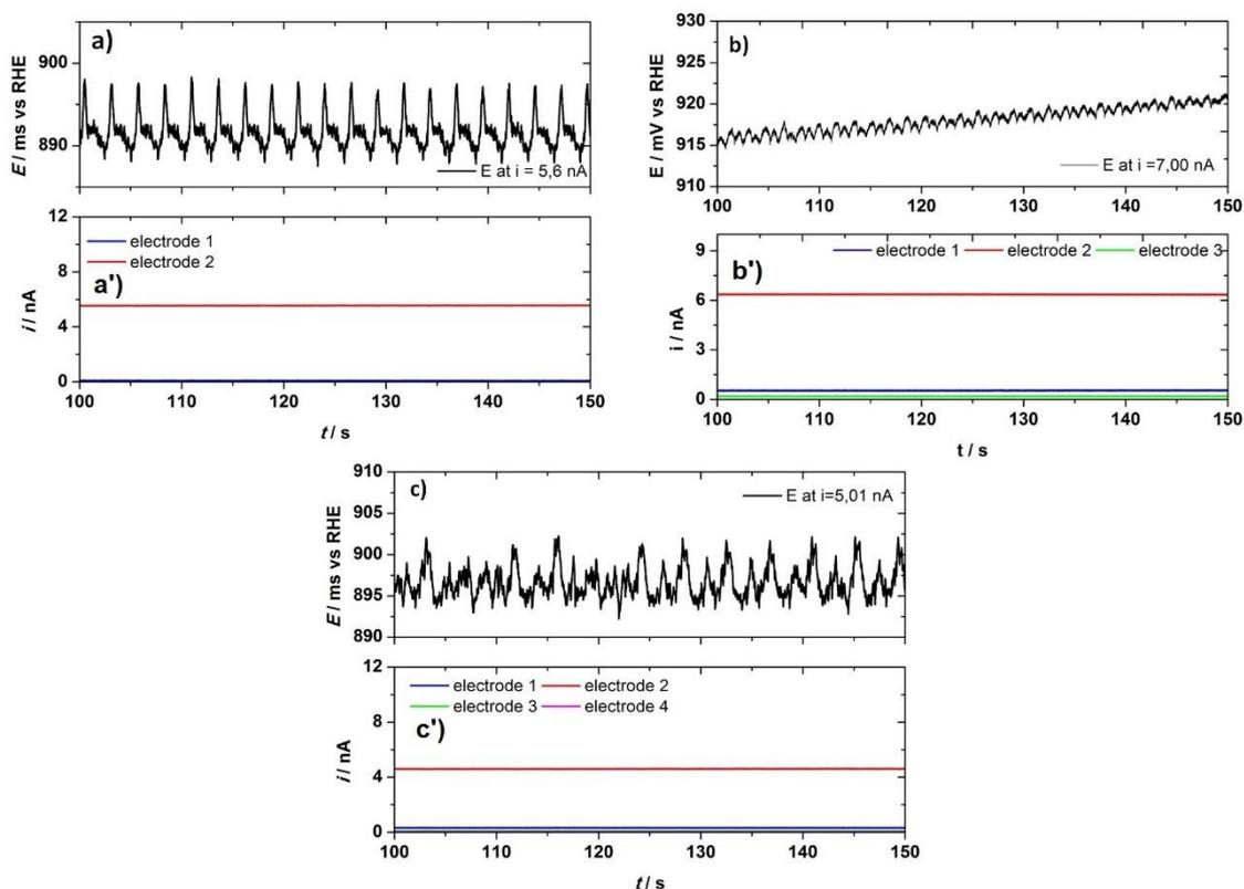
Figure 65 : a), b) et c) Séries temporelles du potentiel (courbes noires) pour un courant constant appliqué durant la réaction d'électrooxydation de CO dans 0,5 mM d' $H_2SO_4$  + 1  $\mu M$  d' $Cl^-$  saturé en CO ; a'), b') et c') les distributions de courant associées (courbes rouges, bleues, vertes et magentas) pour a) deux microélectrodes ; b) trois microélectrodes et c) quatre microélectrodes globalement couplées (a)  $i=5,6$  nA ; b)  $i=7,0$  nA et c)  $i=5,01$  nA).
