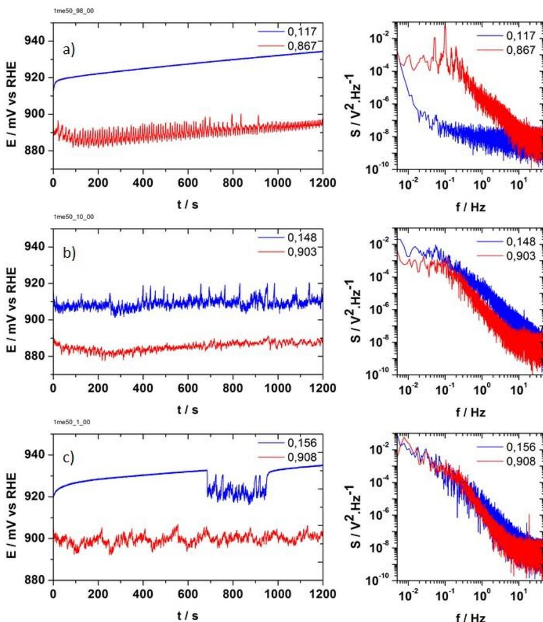
Figure 54 : Séries temporelles du potentiel à différents courants appliqués à une microélectrode de  $50\ \mu\text{m}$  de diamètre dans un électrolyte d'acide perchlorique saturé en CO. a) pour un électrolyte de 98 mM, b) pour un électrolyte de 10 mM et c) pour un électrolyte de 1 mM. Les figures de droite sont respectivement les spectres de puissance associés aux séries temporelles.
