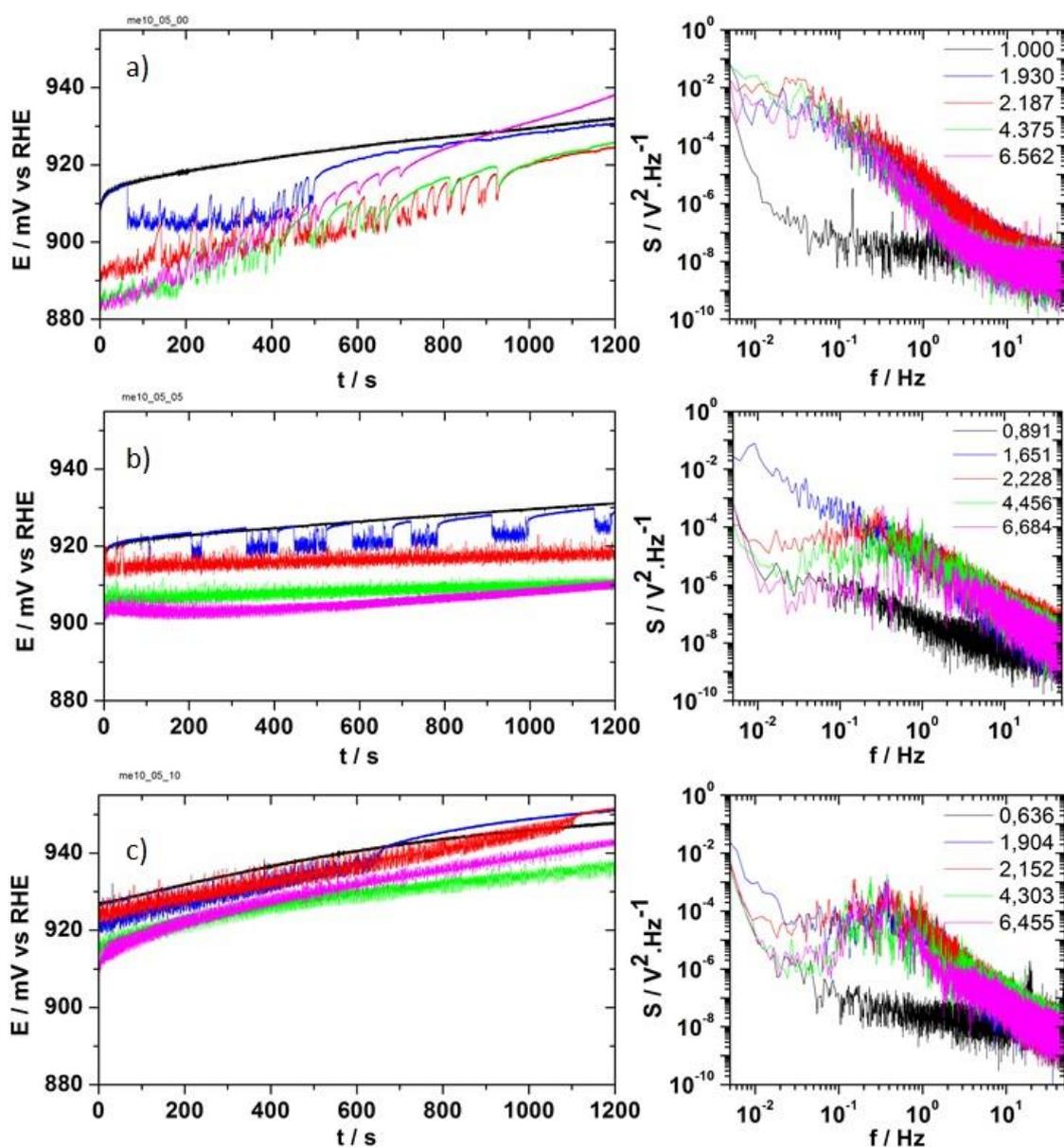
Figure 42: Séries temporelles du potentiel à différents courants appliqués pour une microélectrode de  $10\ \mu\text{m}$  de diamètre dans un électrolyte de  $0,5\ \text{mM}$  d'acide sulfurique saturé en  $\text{CO}$ . a) pour un électrolyte sans chlorures, b) pour un électrolyte avec  $0,5\ \mu\text{M}$  de chlorures et c) pour un électrolyte avec  $1,0\ \mu\text{M}$  de chlorures. Les figures de droite sont respectivement les spectres de densité de puissance associés aux séries temporelles.
