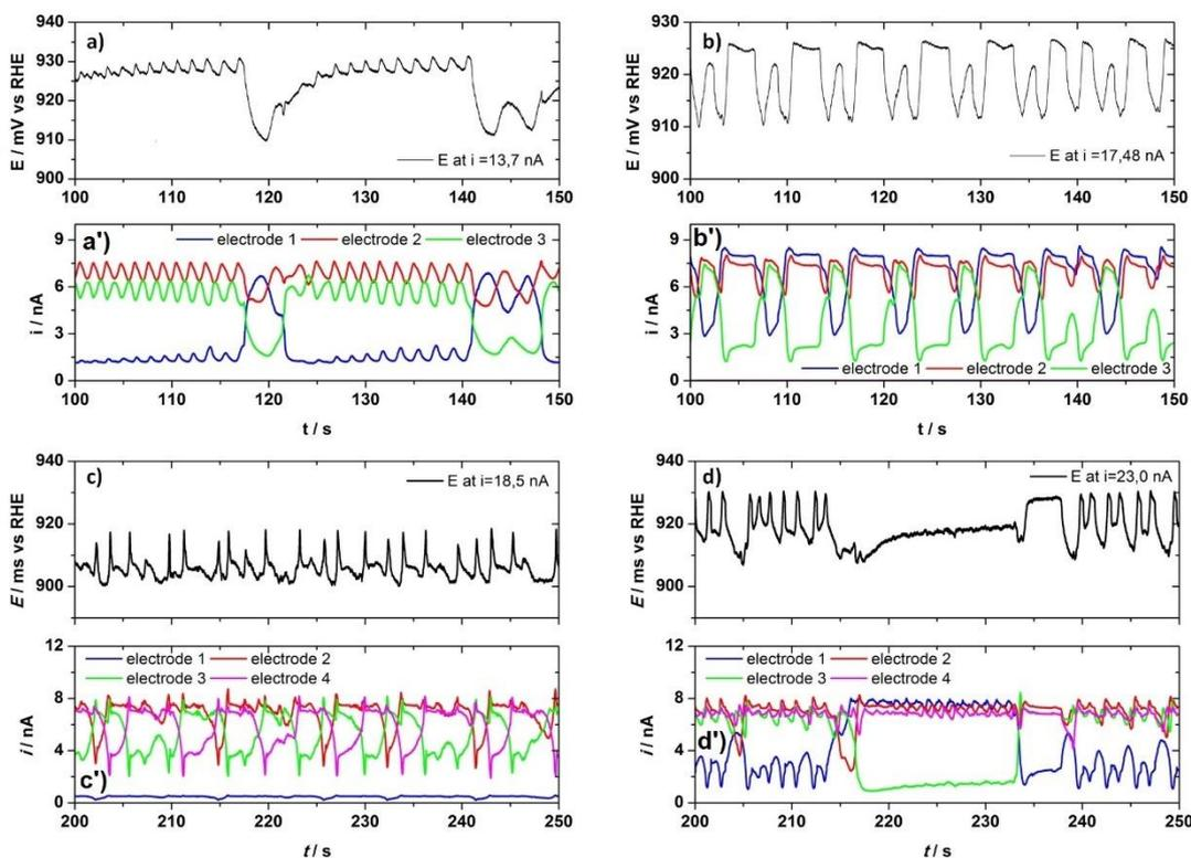
Figure 68 : a), b), c) et d) Séries temporelles du potentiel (courbes noires) pour un courant constant appliqué durant la réaction d'électrooxydation de CO dans 0,5 mM d' $H_2SO_4$  + 1  $\mu M$  d' $Cl^-$  saturé en CO ; a'), b'), c') et d') les distributions de courant associées (courbes rouges, bleues, vertes et magentas) à a et b) trois microélectrodes ; c) et d) quatre microélectrodes globalement couplées (a)  $i=13,7$  nA ; b)  $i=17,48$  nA c)  $i=18,5$  nA et d)  $i=23,0$  nA).
