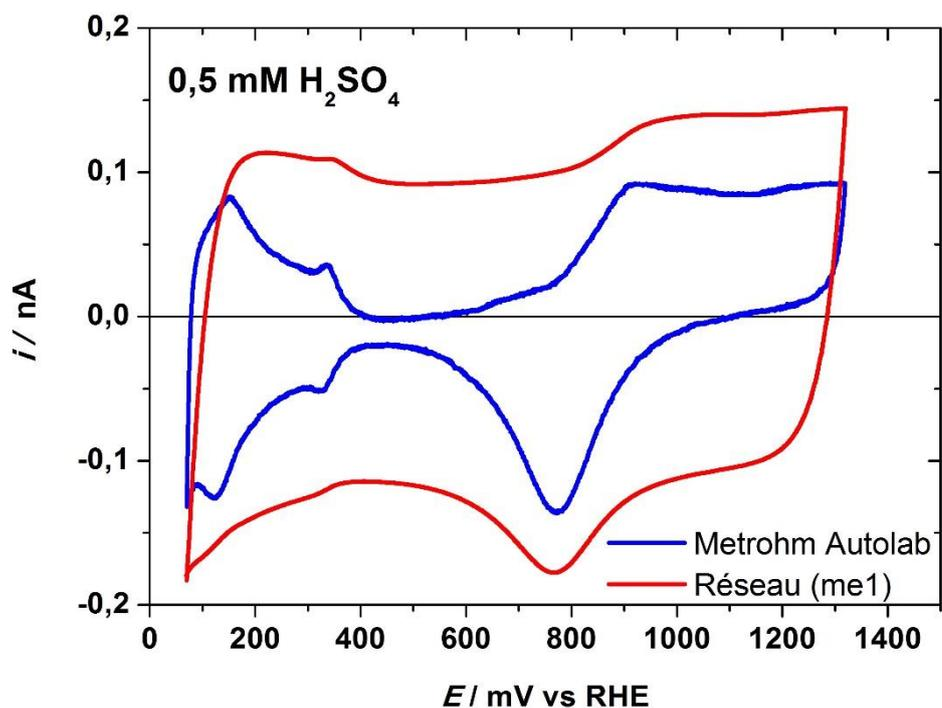
Figure 24 : Cycles voltampérométriques obtenus dans une solution de 0,5 mM d' $H_2SO_4$  saturée en  $N_2$  à  $50mV.s^{-1}$ , pour une microélectrode de  $10\ \mu m$  de diamètre de type commercial Metrohm Autolab (en bleu) et pour une microélectrode de  $9\ \mu m$  de diamètre d'un réseau de microélectrodes (en rouge) acheté au groupe CSEM de Neuchâtel (SUISSE).
