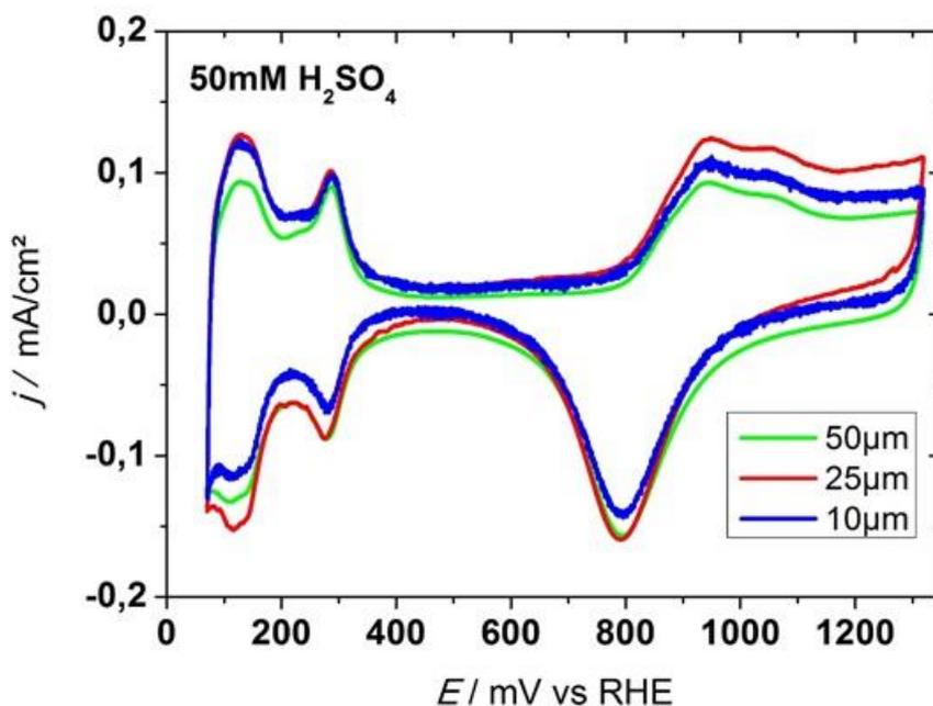
Figure 13 : Cycles voltampérométriques obtenus à  $50 \text{ mV.s}^{-1}$  dans un électrolyte de 50 mM d' $\text{H}_2\text{SO}_4$  purgé en  $\text{N}_2$  pour des microélectrodes Metrohm Autolab de 10 (en bleu), 25 (en rouge) et 50 (en vert)  $\mu\text{m}$  de diamètre. Le courant est normalisé par la surface géométrique.
