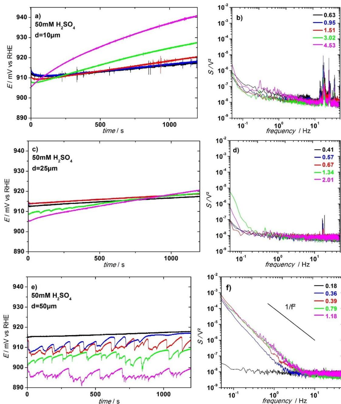
Figure 37 : Séries temporelles (a, c, e) et spectres de densité de puissance correspondants (b, d, f) mesurés à différents courants appliqués (en mA.cm<sup>-2</sup><sub>géo</sub>) comme indiqué par les traits en pointillés sur la Figure 32, pour une microélectrode de platine de a et b) 10  $\mu\text{m}$ ,
