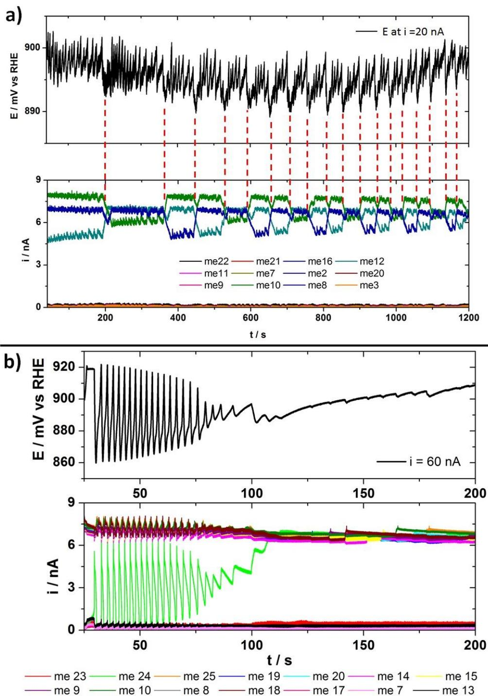
Figure 59 : Sur le panneau du haut, séries temporelles du potentiel pour un courant appliqué constant lors de la réaction d'électrooxydation de CO dans un électrolyte d' $\text{H}_2\text{SO}_4$  0,5 mM saturé de CO a) sur 12, b) sur 14 microélectrodes de platine globalement couplées. Sur le panneau du bas, distribution du courant entre les microélectrodes du système. Pour un courant appliqué de a) 20 nA ; b) 60 nA.
