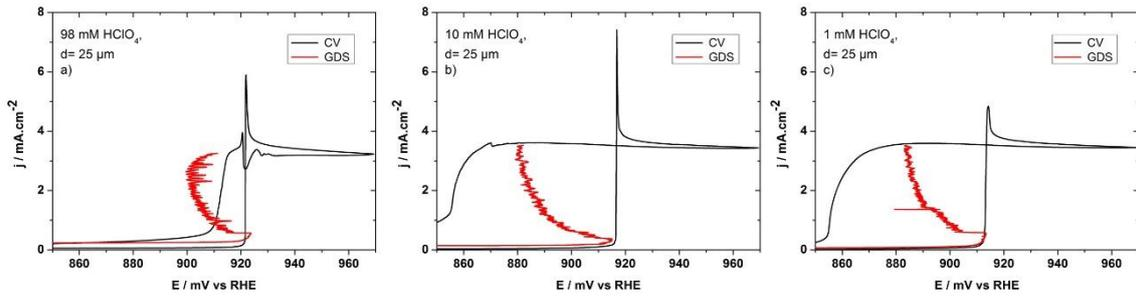
*Annexe 9 : Etude de l'influence de la concentration en acide perchlorique sur une microélectrode de platine de 10  $\mu\text{m}$  de diamètre au cours de la réaction d'électrooxydation du CO dans une solution saturée en CO. a) électrolyte de 98 mM, b) électrolyte de 10 mM, c) électrolyte de 1 mM.*
