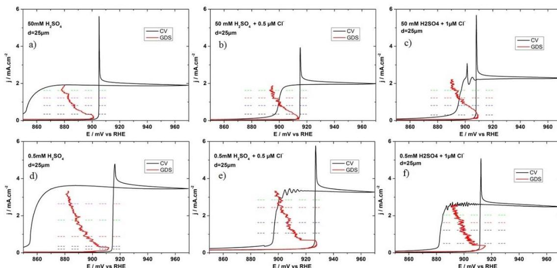
Figure 44: *Etude de l'influence de la concentration en chlorure sur une microélectrode de platine de 25  $\mu\text{m}$  de diamètre au cours de la réaction d'électrooxydation du CO dans une solution d'acide sulfurique à 50 mM (a, b, c) et 0,5 mM (d, e, f) saturée en CO.*
