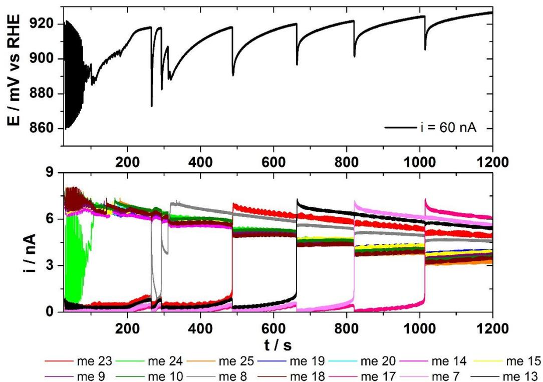
*Annexe 14 : en haut, série temporelle du potentiel pour un courant constant appliqué de 60 nA à quatorze microélectrodes globalement couplées durant la réaction d'électrooxydation de CO dans un électrolyte de 0,5 mM d' $H_2SO_4$  saturé en CO. En bas, la distribution de courant associée à la série temporelle.*
