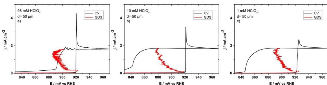
Figure 53 : Etude de l'influence de la concentration en acide perchlorique sur une microélectrode de platine de 50  $\mu\text{m}$  de diamètre au cours de la réaction d'électrooxydation du CO dans une solution saturée en CO. a) électrolyte de 98 mM, b) électrolyte de 10 mM, c) électrolyte de 1 mM.
