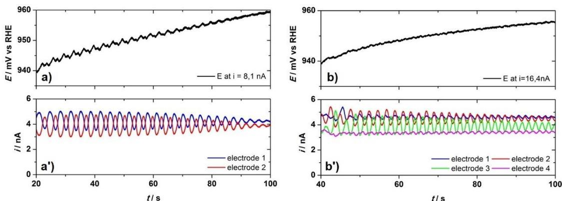
Figure 63 : a) et b) Séries temporelles du potentiel (courbes noires) pour un courant appliqué à des microélectrodes globalement couplées durant la réaction d'électrooxydation de CO dans 50 mM d' $H_2SO_4$  + 1  $\mu M$  d' $Cl^-$  saturé en CO ; a') et b') les distributions de courant associées (en bas, courbes rouges, bleues, verte ou magenta). a) pour deux microélectrodes couplées à  $i=8,15$  nA ; b) pour quatre microélectrodes à  $i=16,4$  nA.
