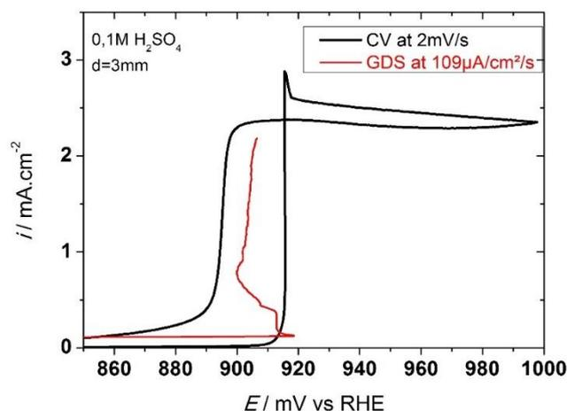
Figure 31 : Courbe voltampérométrique mesurée à  $2 \text{ mV}\cdot\text{s}^{-1}$  (CV, courbe noire) et courbe galvanodynamique mesurée à  $109 \mu\text{A}\cdot\text{cm}^{-2}\cdot\text{s}^{-1}$  (GDS, courbe rouge) sur une électrode à disque tournant (à 2500 rpm) de platine de 3 mm de diamètre dans un électrolyte de  $\text{H}_2\text{SO}_4$  0,1 M saturé en CO. Reproduit de la référence bozdech et al<sup>71</sup> avec la permissions de « The Royal Society of Chemistry ».
