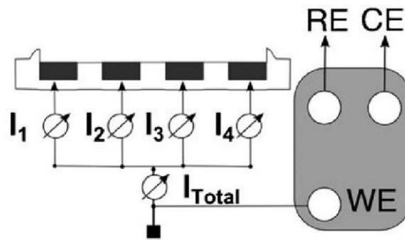
Figure 8 : *Mesure de la distribution de courant pour quatre microélectrodes court-circuitées*<sup>34</sup>.
