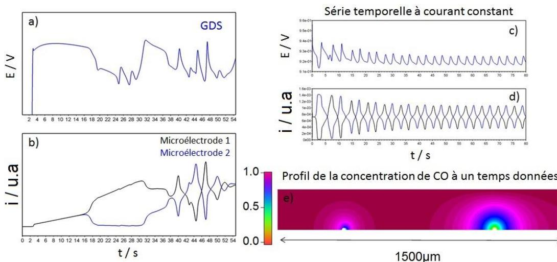
Figure 70 : a) Simulation par des méthodes d'éléments finis des courbes de balayage de courant lors de l'oxydation de CO pour un système de deux microélectrodes globalement couplées en présence d'1  $\mu\text{M}$  de chlorures) ; b) distribution du courant entre les deux microélectrodes du système durant le balayage en courant. c) série temporelle du potentiel obtenue à un courant appliqué constant et d) la distribution de courant associée
