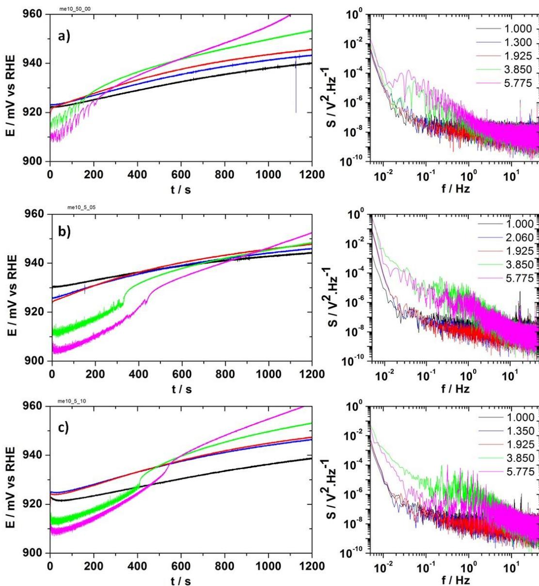
*Annexe 6 : Séries temporelles du potentiel à différents courants appliqués à une microélectrode de  $10 \mu m$  de diamètre dans un électrolyte de 5 mM d'acide sulfurique saturé en CO. a) pour un électrolyte sans chlorures, b) pour un électrolyte avec  $0,5 \mu M$  de chlorures et c) pour un électrolyte avec  $1,0 \mu M$  de chlorures. Les figures de droite sont respectivement les spectres de puissance associés aux séries temporelles.*
