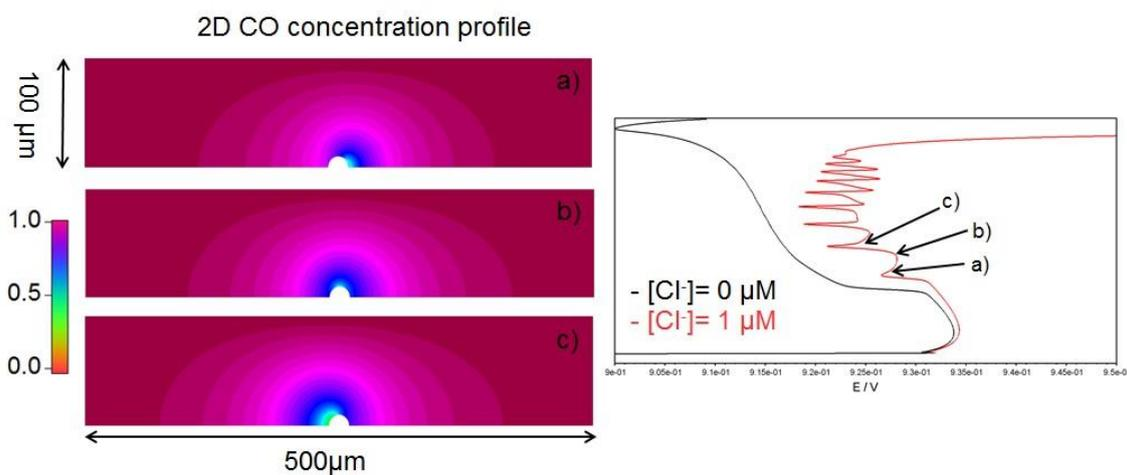
Figure 50 : à droite, les courbes galvanodynamiques pour la réaction d'oxydation de CO sur une microélectrode de 10  $\mu\text{m}$  de diamètre de Platine, en noir sans chlorure et en rouge avec 1,0  $\mu\text{M}$  de chlorure. A gauche, les profils de la concentration de CO (a, b et c) correspondent respectivement à ceux enregistrés durant la GDS aux coordonnées indiquées par les flèches.
