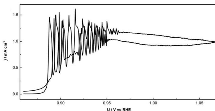
Figure 39 : Courbe voltampérométrique à  $1 \text{ mV}\cdot\text{s}^{-1}$  d'une électrode à disque tournante de Pt pour la réaction d'électrooxydation de CO dans un électrolyte  $0,5 \text{ M H}_2\text{SO}_4 + 1 \mu\text{M HCl}$  saturé en CO (tirée de <sup>32</sup>Malkhandi et al., *Surface Science*, 2009).
