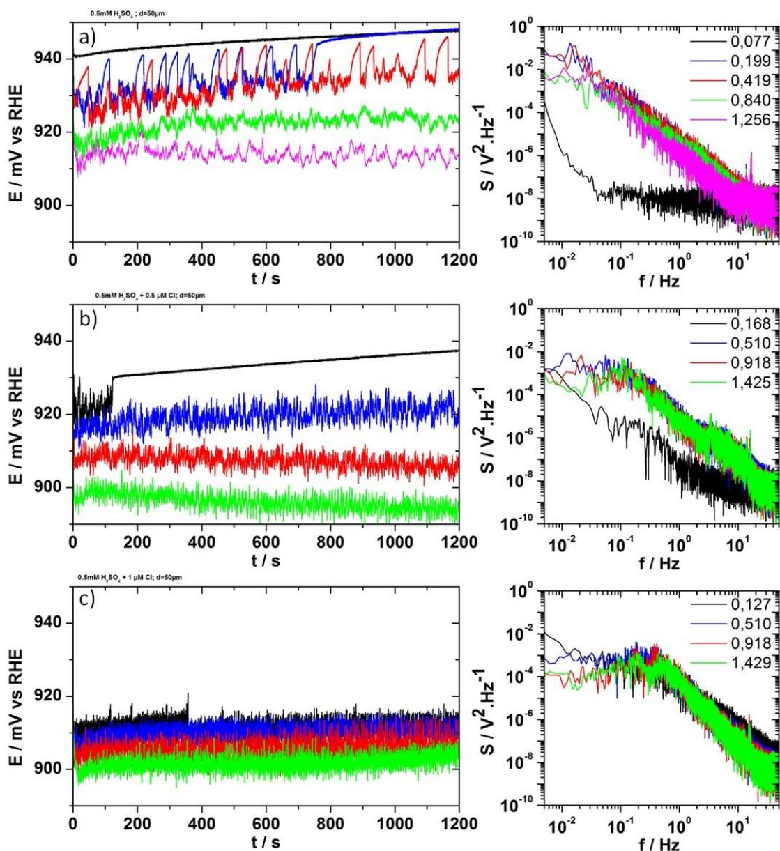
*Annexe 8 : Sériés temporelles du potentiel à différents courants appliqués à une microélectrode de 50  $\mu m$  de diamètre dans un électrolyte de 0,5 mM d'acide sulfurique saturé en CO. a) pour un électrolyte sans chlorures, b) pour un électrolyte avec 0,5  $\mu M$  de chlorures et c) pour un électrolyte avec 1,0  $\mu M$  de chlorures. Les figures de droite sont respectivement les spectres de puissance associés aux séries temporelles.*
