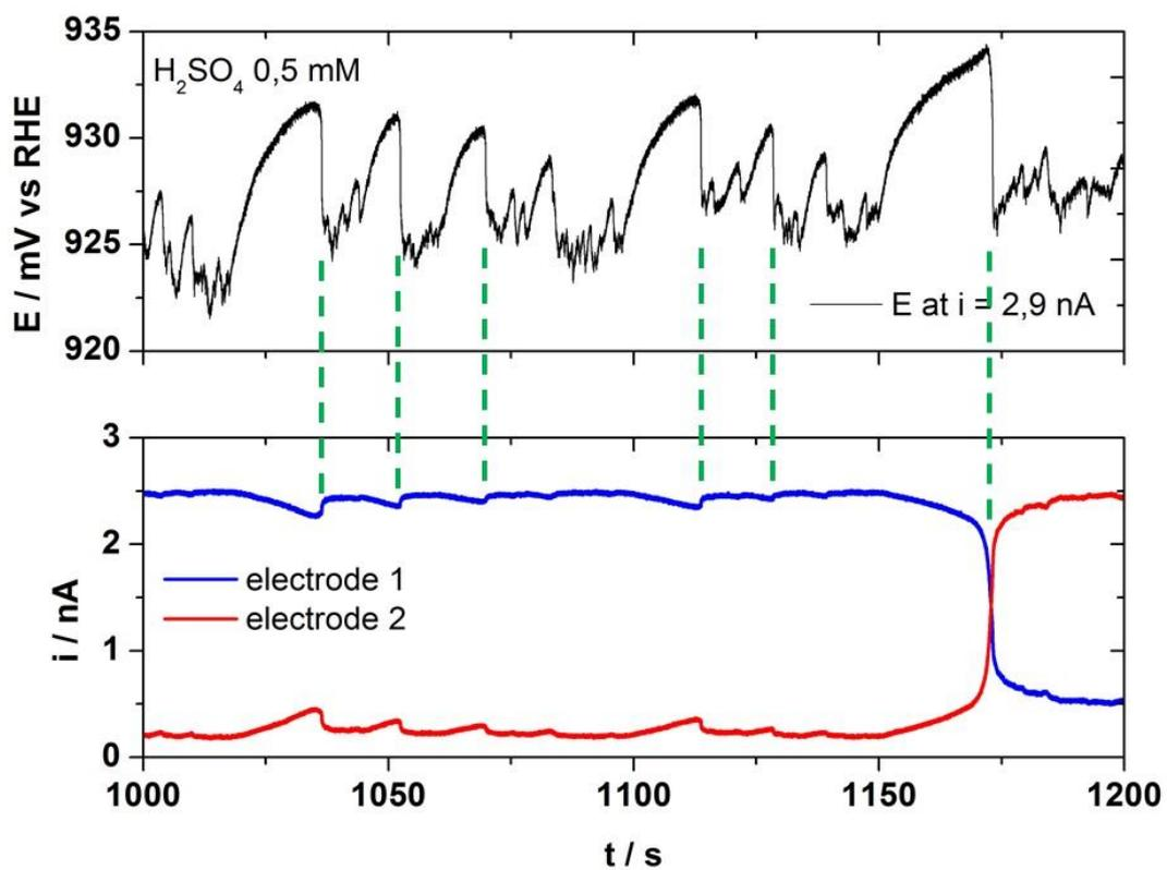
*Annexe 13* : en haut, série temporelle du potentiel pour un courant constant appliqué de 2,9 nA à deux microélectrodes globalement couplées durant la réaction d'électrooxydation de CO dans un électrolyte de 0,5 mM d' $\text{H}_2\text{SO}_4$  saturé en CO. En bas, la distribution de courant associée à la série temporelle.
