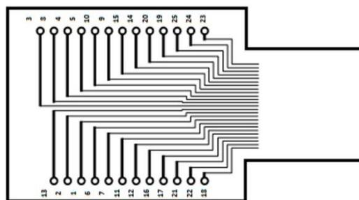
Figure 23 : Typon utilisé lors de la réalisation du circuit imprimé du support de réseau de microélectrodes permettant de relier les microélectrodes aux appareils de mesure.
