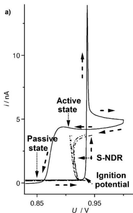
Figure 7 : en trait noir plein, le cycle voltampérométrique obtenu à  $50 \text{ mV.s}^{-1}$  pour une microélectrode de Pt de  $10 \mu\text{m}$  de diamètre dans un électrolyte de  $50 \text{ mM}$  d' $\text{H}_2\text{SO}_4$ . Les traits en pointillés correspondent à la réponse en potentiel lorsque qu'un balayage en courant est appliqué à l'électrode. Tiré de Crespo et al<sup>34</sup>.
