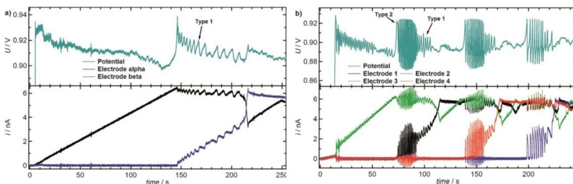
Figure 11 : panneaux du haut, potentiel enregistré lors d'une augmentation de courant, pour la réaction d'électrooxydation de CO dans un électrolyte de 0,5 mM d' $\text{H}_2\text{SO}_4$  saturé de CO. Panneau du bas, les courbes de distribution du courant entre les différentes électrodes du système. a) pour deux microélectrodes Metrohm Autolab ; b) pour quatre microélectrodes en réseau. Figure tirée de Crespo et Al<sup>35</sup>.
