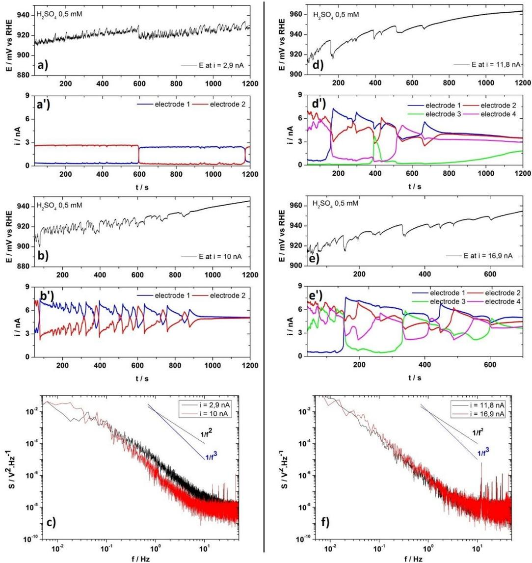
Figure 56 : a), b), d) et e) Séries temporelles du potentiel pour différents courants appliqués à a et b) 2 microélectrodes ; d et e) 4 microélectrodes globalement couplées de  $10\mu\text{m}$  de diamètre dans un électrolyte de  $0,5\text{ mM}$  d'acide sulfurique saturé en  $\text{CO}$  ; a'), b'), d') et e') Les courbes de distribution du courant associées respectivement. e) et f) Spectres de densité de puissance associés aux séries temporelles du potentiel de a, b, d et e.
