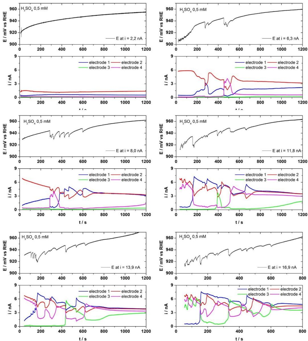
*Annexe 12 : en haut, série temporelle du potentiel pour différents courants constants appliqués à quatre microélectrodes globalement couplées durant la réaction d'electrooxydation de CO dans un électrolyte de 0,5 mM d' $H_2SO_4$  saturé en CO. En bas, la distribution de courant associée à la série temporelle.*
