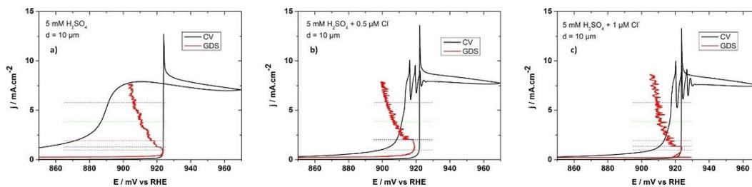
*Annexe 3 : Etude de l'influence de la concentration en chlorures sur une microélectrode de platine de 10  $\mu\text{m}$  de diamètre au cours de la réaction d'électrooxydation de CO dans une solution d'acide sulfurique à 5 mM saturée en CO. a) électrolyte sans chlorures, b) électrolyte avec 0,5  $\mu\text{M}$  de chlorures, c) électrolyte avec 1,0  $\mu\text{M}$  de chlorures.*
