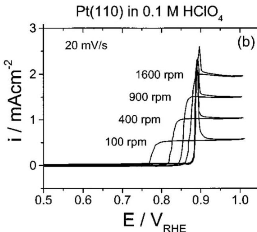
Figure 5 : Cycle voltampérométrie sur une électrode à disque tournante de Pt(110) dans un électrolyte de 0,1 M d' $\text{HClO}_4$  à différentes vitesses de rotation. Figure de la publication de Koper et al.<sup>24</sup>.
