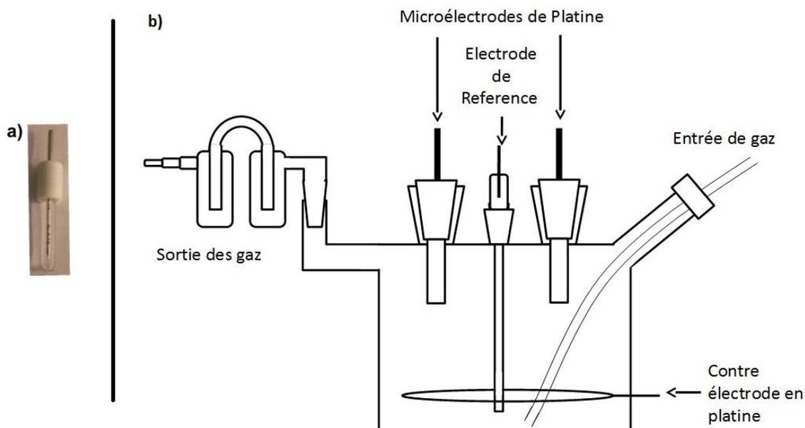
Figure 12 : a) Photographie d'une microélectrode de platine Metrohm Autolab de  $10 \mu\text{m}$  de diamètre. b) schéma de la cellule électrochimique à un compartiment en verre pour l'étude de l'électrooxydation de CO sur une ou plusieurs microélectrodes de platine Metrohm Autolab.
