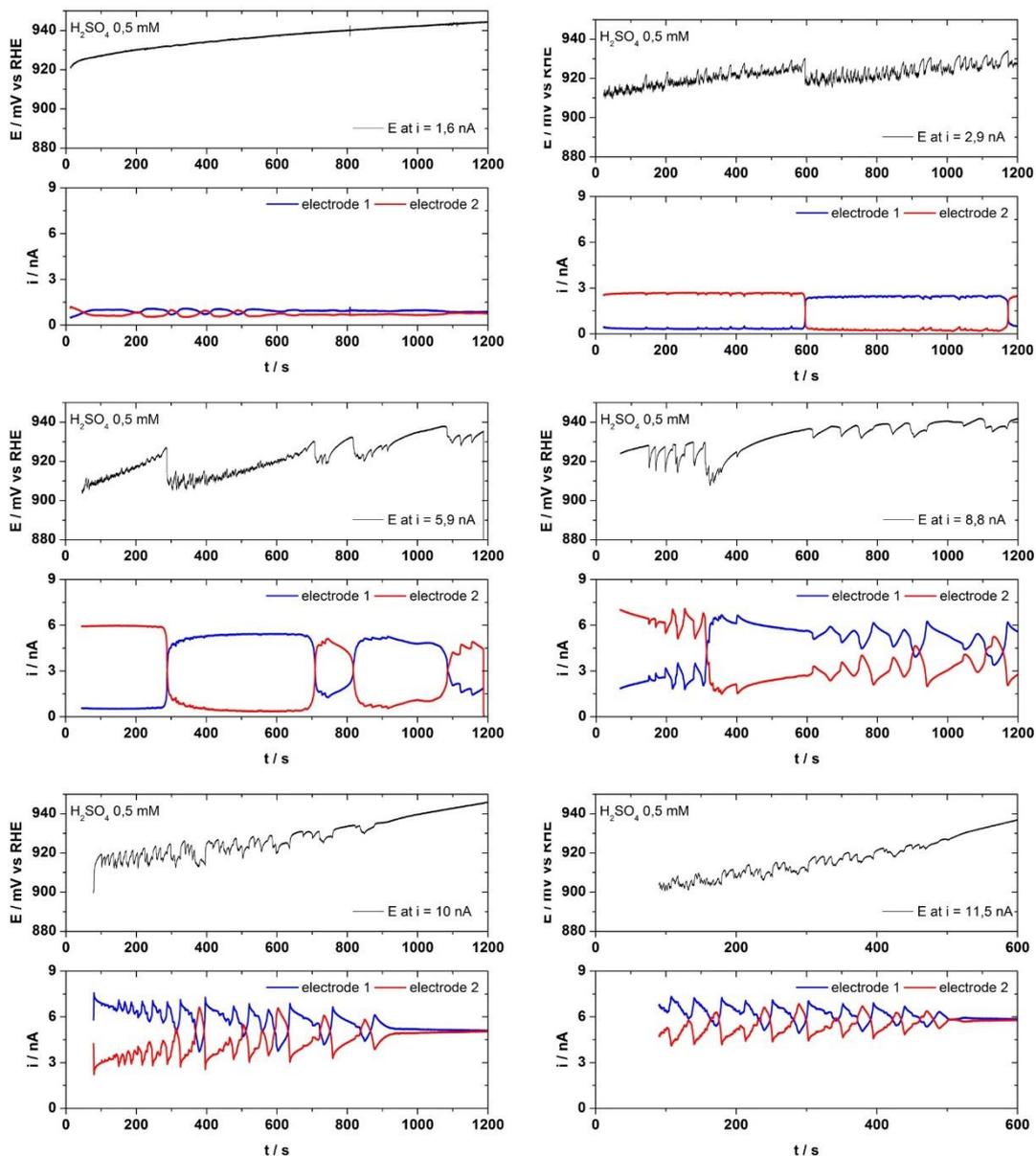
*Annexe II : en haut, série temporelle du potentiel pour différents courants constants appliqués à deux microélectrodes globalement couplées durant la réaction d'électrooxydation de CO dans un électrolyte de 0,5 mM d' $\text{H}_2\text{SO}_4$  saturé en CO. En bas, la distribution de courant associée à la série temporelle*
