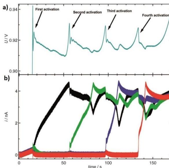
Figure 10 : a) panneau du haut, potentiel enregistré lors d'une augmentation de courant, pour la réaction d'électrooxydation de CO dans un électrolyte de 50 mM d'H<sub>2</sub>SO<sub>4</sub> saturé de CO. Panneau du bas, les courbes de distribution du courant entre les différentes électrodes du système pour quatre microélectrodes en réseau. Figure tirée de Crespo et Al<sup>34</sup>.
