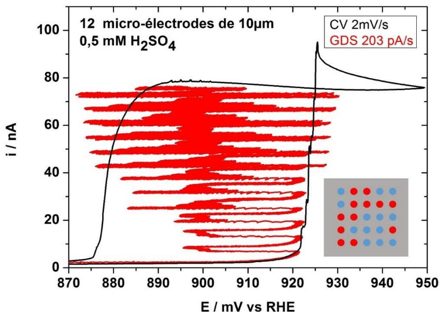
Figure 57 : Courbe voltampérométrique (en noir) et courbe galvanodynamique (en rouge) pour 12 microélectrodes de 10  $\mu\text{m}$  de diamètre de platine d'un réseau de microélectrodes globalement couplées pour la réaction d'oxydation de CO dans 0,5 mM d' $\text{H}_2\text{SO}_4$  saturé en CO. En insert, un schéma représentant la disposition des électrodes du réseau durant les mesures, en rouge les électrodes utilisées et en bleu celles qui ne sont pas utilisées.
