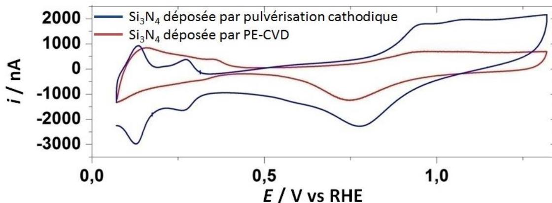
Figure 25 : Cycle voltampérométrie à  $50 \text{ mV.s}^{-1}$  pour une microélectrode d'un réseau de microélectrode fabriqué à Strasbourg dans  $\text{H}_2\text{SO}_4$  0,5 mM saturé en  $\text{N}_2$ . Pour une couche de nitrure déposée en bleu, par pulvérisation cathodique et en rouge, par dépôt chimique en phase vapeur assisté par plasma (PE-CVD).
