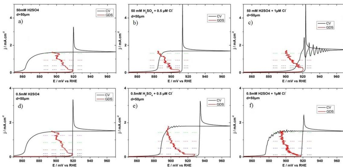
Figure 45 : *Etude de l'influence de la concentration en chlorures sur une microélectrode de platine de 50  $\mu\text{m}$  de diamètre au cours de la réaction d'électrooxydation du CO dans une solution d'acide sulfurique à 50 mM (a, b, c) et 0,5 mM (d, e, f) saturée en CO. a et*
