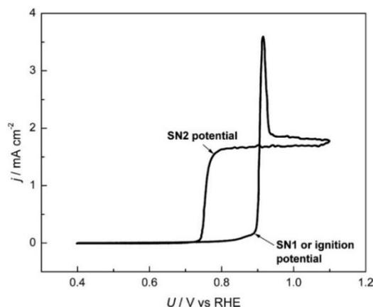
Figure 4 : Cycle voltampérométrique sur une électrode de Pt polycristalline ( $0,2 \text{ cm}^2$ ) à disque tournante dans un électrolyte  $0,1 \text{ M}$  d' $\text{HClO}_4$  saturé en CO pour une vitesse de balayage de  $50 \text{ mV.s}^{-1}$  et une vitesse de rotation de l'électrode de  $1200 \text{ rpm}$ . Figure tirée de la publication de Malkhandi et al.<sup>32</sup>.
