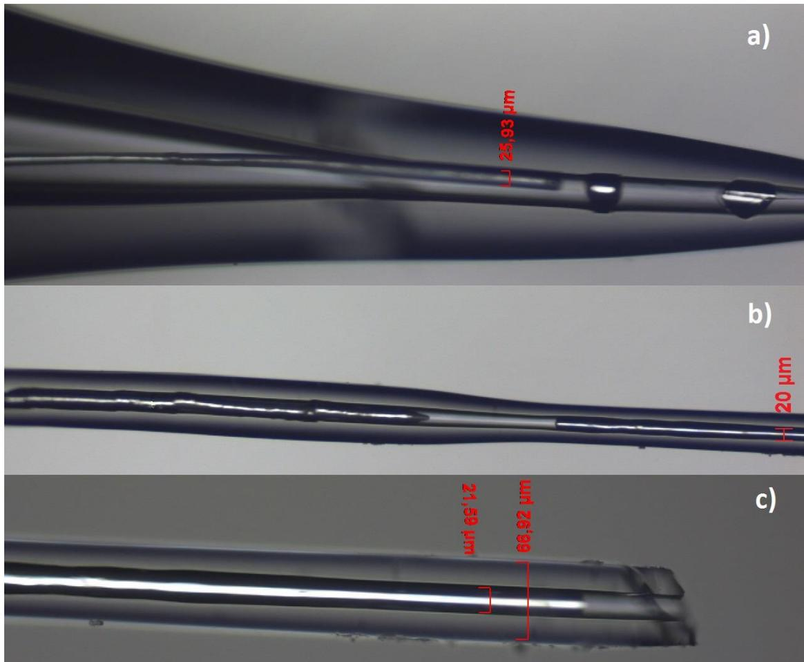
Figure 30 : Les images obtenues par microscope optique montrent les microélectrodes obtenues après la dernière étape d'étirement. a) le fil de platine de 25  $\mu\text{m}$  de diamètre est sectionné, il est aussi remarqué que le fil de platine n'est pas scellé avec le quartz. b) Le fil de platine est légèrement étiré (passant de 25 à 20  $\mu\text{m}$ ) cependant il est craquelé. c) image montrant l'extrémité de la microélectrode exposée sur l'image b.
