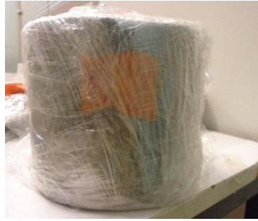
Figure III-11 Phase d'équilibrage de la succion (échantillon recouvert d'un film plastique et conservé dans une salle climatisée)
