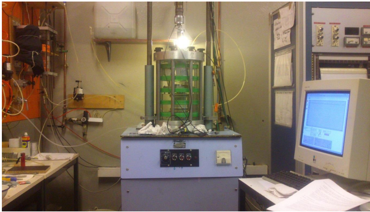
Figure II-19 : Dispositif expérimental utilisé lors des essais triaxiaux de référence sur sable limoneux de Gavet
