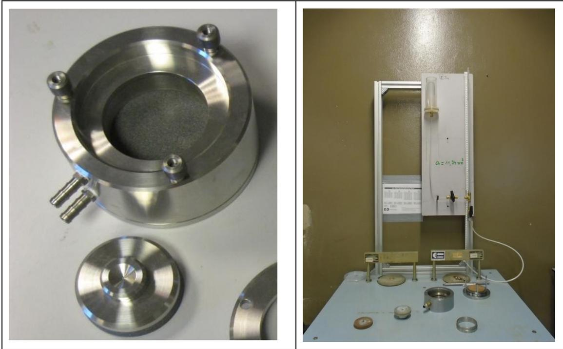
*Figure II-12 : Dispositifs d'œdomètre – perméamètre utilisés lors des essais de chargement œdométrique.*
