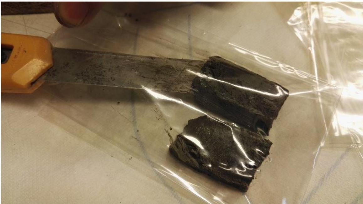
*Figure A II-2 La fabrication et mise en place des petites éprouvettes pour l'essai rétention d'eau par méthode osmotique*
