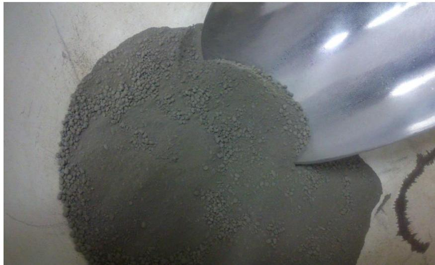
*Figure II-2 : Matériau Gavet passant à 2 mm (état sec)*
