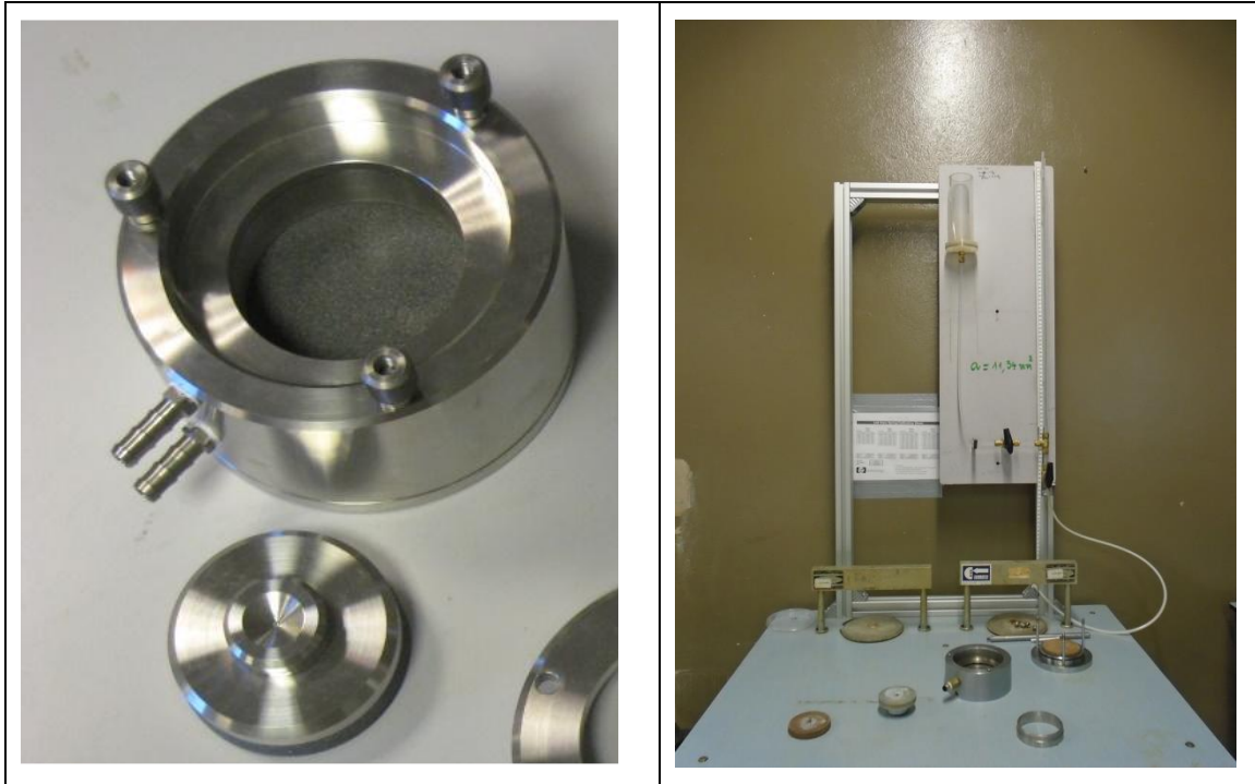
Figure II-12 : Dispositifs d'œdomètre – perméamètre utilisés lors des essais de chargement œdométrique.
