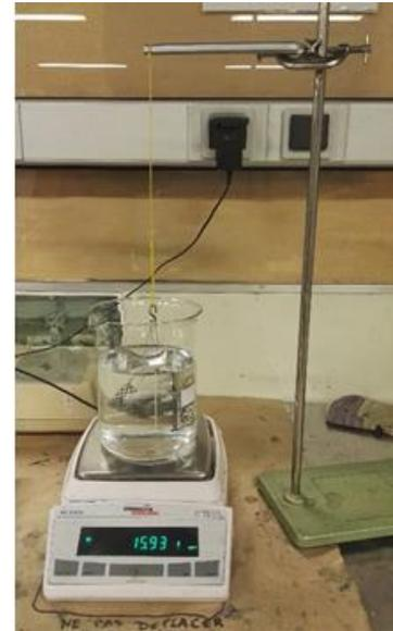
*Figure A II-3 : Les éprouvettes paraffinés et la pesée hydrostatique pour mesure le volume et degré de saturation*
