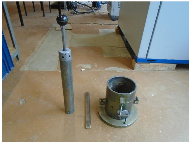
Figure III-2 Appareillage pour l'essai Proctor à l'ENTPE, de gauche à droite : dame Proctor Normal, règle à araser, moule CBR
