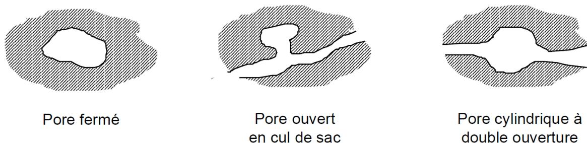
Figure 6 : Différents types de pores, d'après de Marsily (1986)
