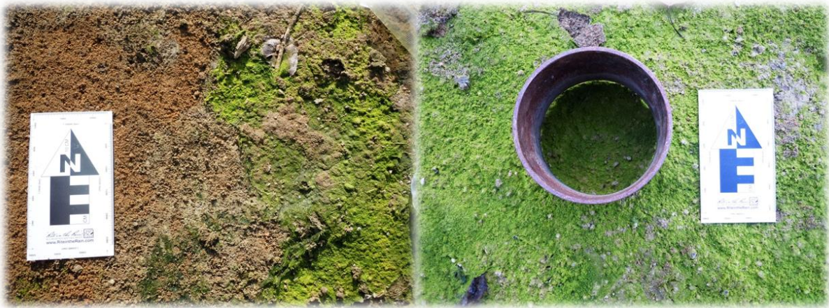
Figure 32 : Photos des essais Beerkan, photos LEHNA.
