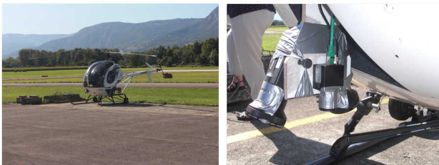
Figure 1.8 – Dispositif expérimental mis en œuvre à Grenoble : hélicoptère et caméras
