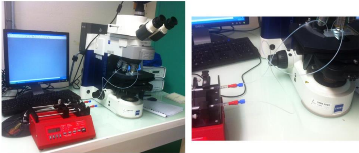
Figure 84 : Présentation du système expérimental (pousse seringue à deux voies Ne-4000 New Era Pump Systems Inc pour l'injection des solutions et microscope Zeiss Axio Imager pour l'observation des particules fluorescentes circulant dans la chambre microfluidique).
