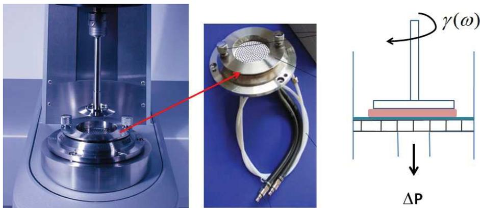
FIGURE III.3 – Gauche : cellule d'immobilisation montée sur le rhéomètre MCR 501 et détail de la géométrie inférieure comprenant la grille. Droite : schéma du montage vu de côté, avec la suspension (en rose) et le filtre (en bleu).
