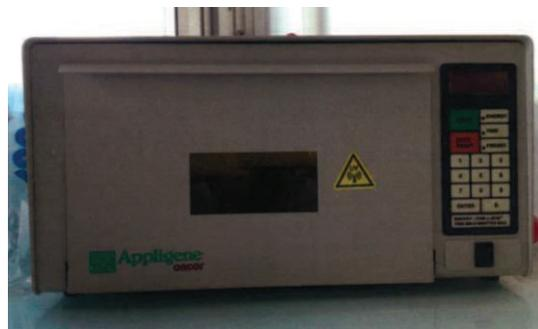
Figure II.4.17 : lampe et four utilisés pour la stérilisation par irradiation aux rayons UV des enzymes. Les détails techniques des appareils sont fournis dans la partie Matériels et Méthodes 2.7.1).
