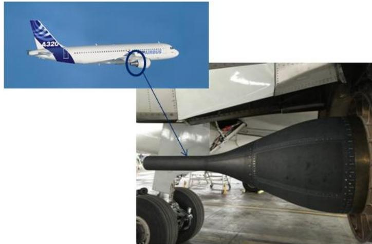
**Figure 1 - Arrière-corps en composite à matrice céramique de type A40C (programme ARCOCE) monté sur A320 [Safran2015]**
