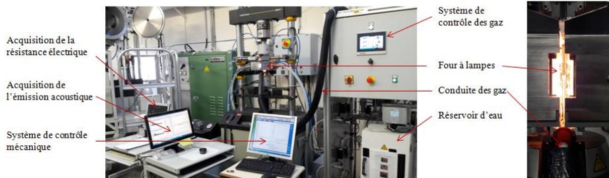
**Figure II.6 - Dispositif de traction Instron 8861, équipé pour des essais en traction à haute température et atmosphère contrôlée avec moyens de suivi**
