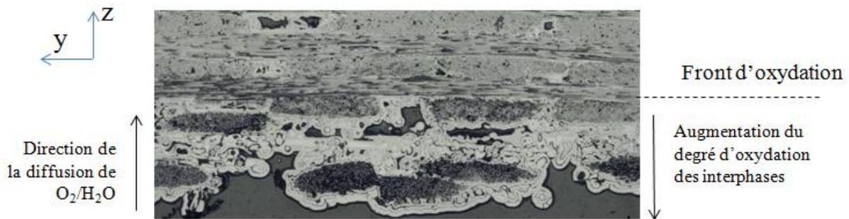
Figure IV.14 - Micrographie d'une coupe dans le plan  $(y,z)$  de l'éprouvette ayant subi l'essai statique à 100 MPa et 450°C sous  $P(H_2O)=10$  kPa, rupture à 160 h (surface du bas de l'image: surface de l'éprouvette) [Simon2017\_Acta2]
