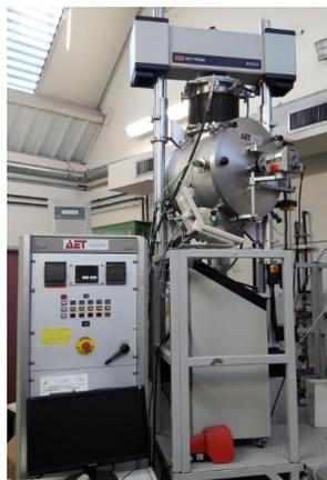
Figure II.7 – Dispositif de traction à haute température sous vide ou gaz neutre (Instron 8562)
