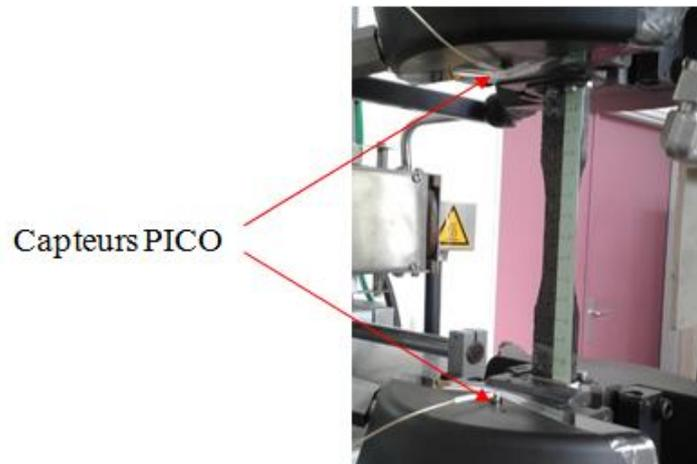
**Figure II.13 - Placement des capteurs PICO pour un essai à haute température, et réglette d'étalonnage positionnée sur l'éprouvette**
