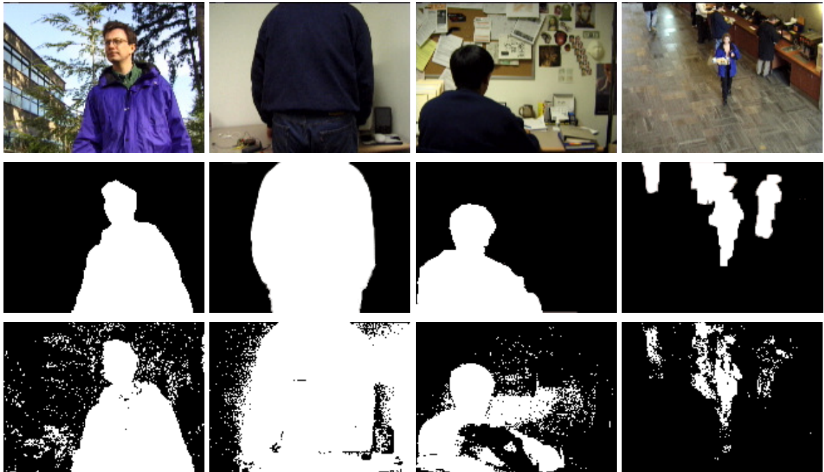
FIGURE 3.1 – Résultats de la détection. Sur la première ligne nous avons les images originales, sur la seconde nous avons les vérités de terrain (détection idéale). La troisième ligne montre l’extraction de premier plan réalisée par la méthode de “Codebook”.
