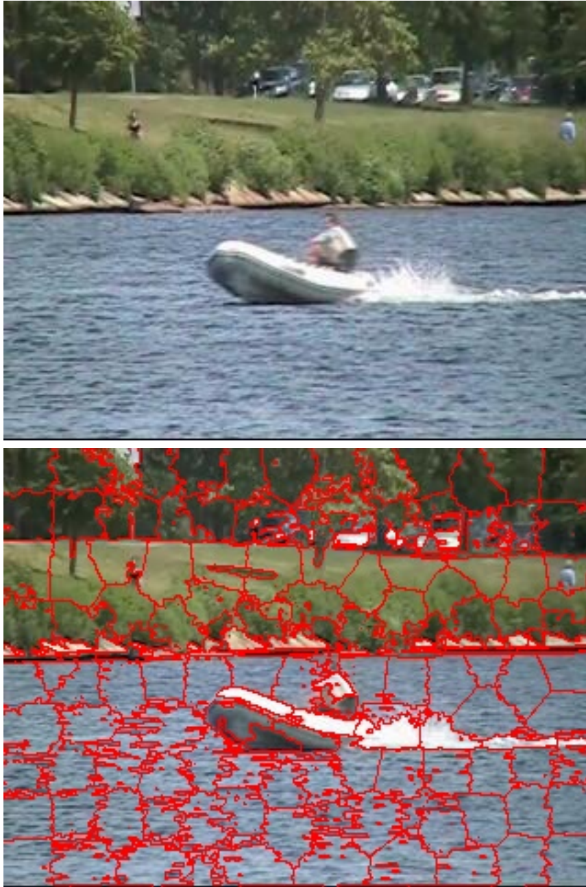
FIGURE 3.4 – Segmentation en superpixels. La première ligne représente l'image originale tandis que la seconde représente le résultat de la segmentation en superpixels.
