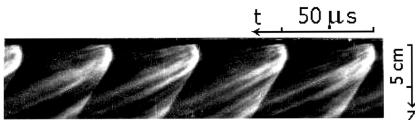
FIGURE 2.16 – Enregistrement de la propagation d'une RD dans un mélange C_3H_8 - O_2 , extrait de Bykovskii et al. [77].
