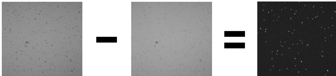
FIGURE 3.9 – Traitement des images brutes. À chaque image brute acquise, on soustrait une image de fond, calculée en prenant le maximum de niveau de gris sur chaque pixel.
