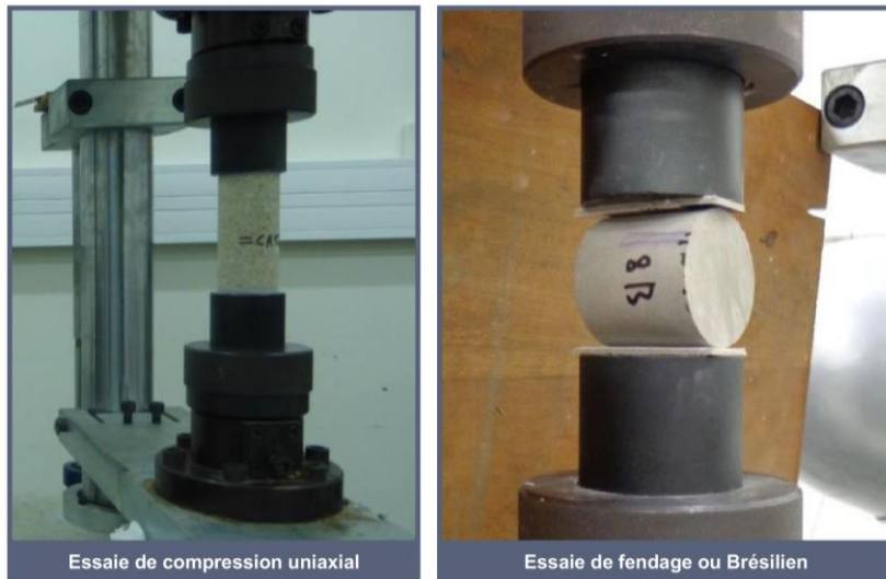
Figure 48 : Dispositifs pour la résistance à la rupture et la rigidité.
