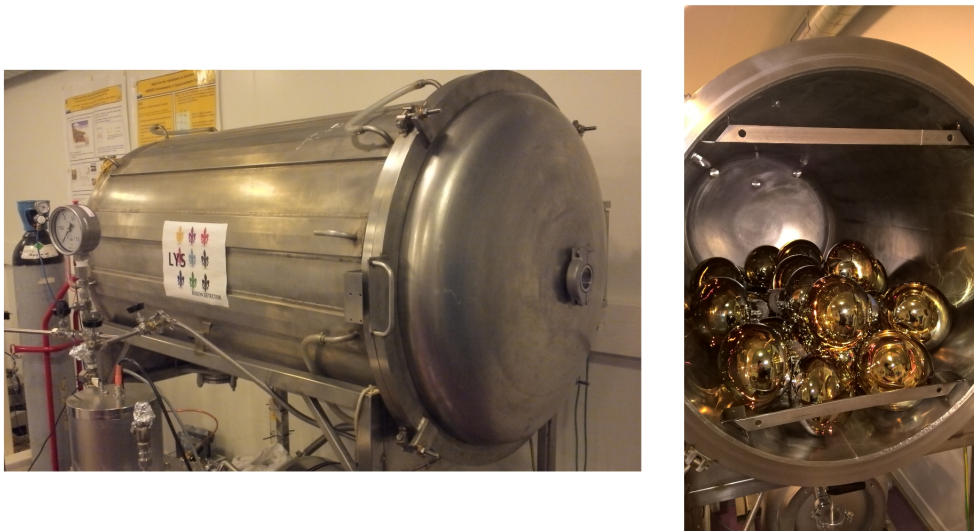
FIGURE 2.14: Photographie de l'extérieur (gauche) et de l'intérieur (droite) de la grande chambre d'émanation du CENBG dans laquelle des photomultiplicateurs 8" ont été disposés avant la mesure de leur émanation.
