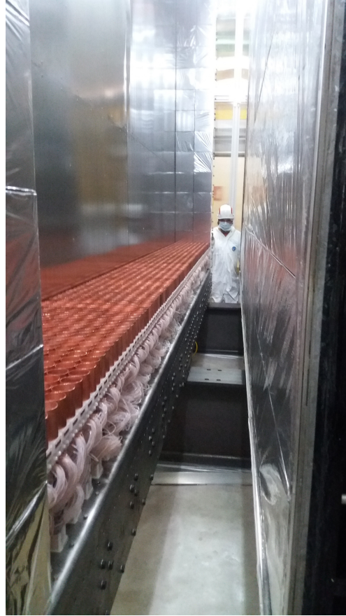
FIGURE 2.5: Photographie représentant la phase de liaison entre une partie du trajectographe et du calorimètre du démonstrateur de SuperNEMO.
