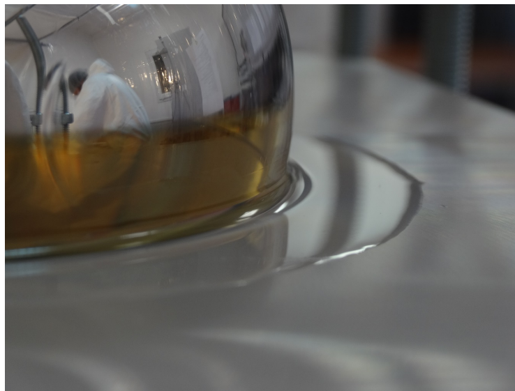
FIGURE 3.17: Photographie représentant le couplage optique effectué entre le scintillateur et le photomultiplicateur par de la colle RTV615. L'excédent de colle après séchage est retiré avant l'habillage du scintillateur.
