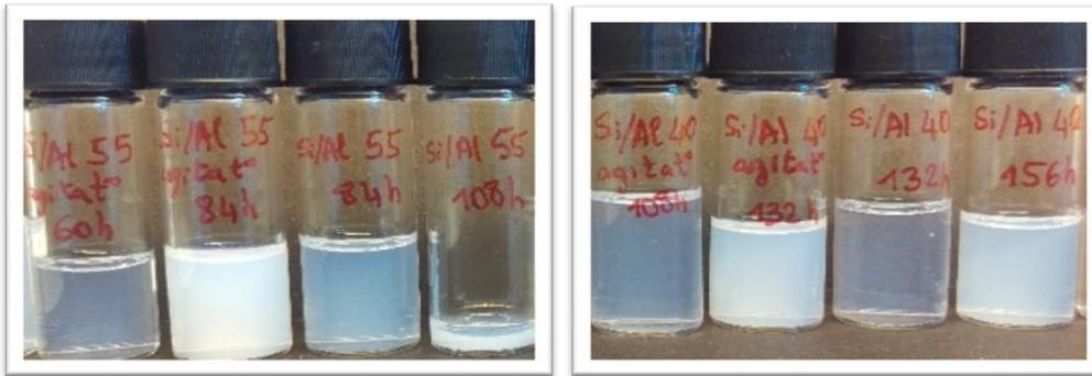
Figure II-15 : photographie des suspensions colloïdales (à droite Si/Al=55 ; à gauche Si/Al=40) obtenues après différentes durées de traitement hydrothermal et avec et sans agitation montrant l'opalescence bleutée (temps minimal de traitement hydrothermal) et l'opalescence laiteuse (temps maximal de traitement hydrothermal)
