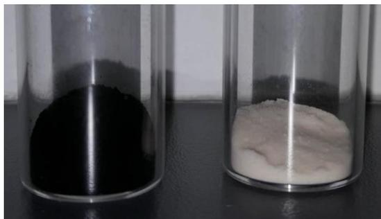
*Figure III-18 : photographie de l'échantillon ZSM-5/CNT-0,3g après calcination à 500°C (à gauche) et après calcination à 700°C (à droite)*
