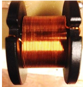
Figure 1.13: Solénoïde réalisé au laboratoire
