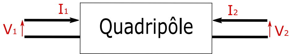
Figure A.17: Tensions et courants dans un quadripôle
