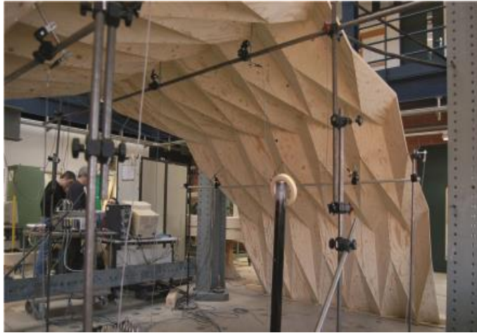
Fig. 14 Essais mécaniques sur une structure plissée
