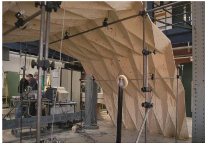
Fig. 14 Essais mécaniques sur une structure plissée
