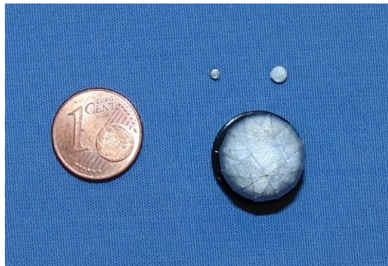
Figure 48. Comparaison des tailles des marqueurs de 1,5, 3 et 14 mm à une pièce de 1 centime d'euro.
