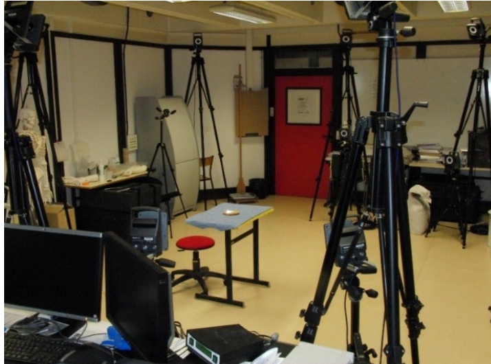
Figure 46. Salle expérimentale de capture du mouvement composée de 17 caméras optoélectroniques Vicon T160.
