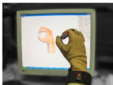
Figure 40. Utilisation du CyberGlove pour le tracking des postures de la main (Cobos et al. , 2010).
