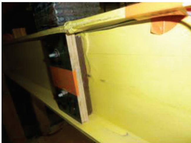
FIGURE 5.20: L'écrasement de la semelle supérieure de Pu1
