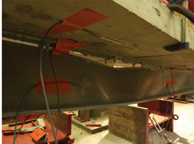
FIGURE 5.43: La ruine de PB8 par cisaillement de l'interface suivi par cisaillement du profilé
