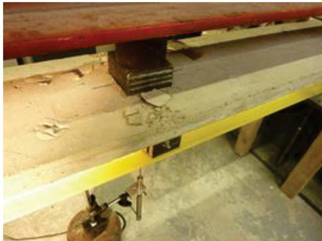
FIGURE 5.26: L'écrasement du béton dans PB2
