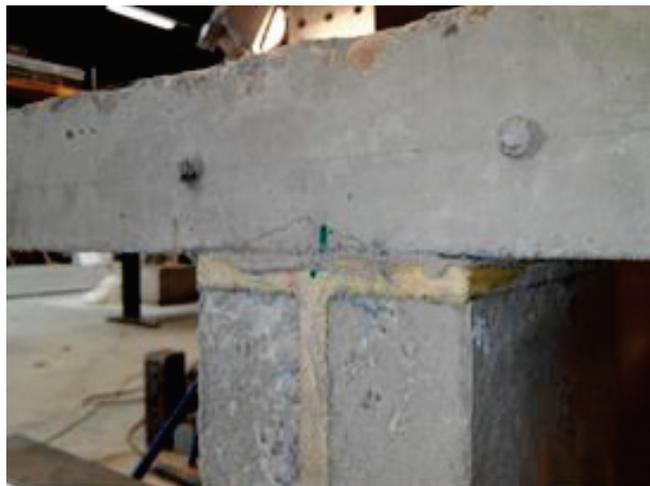
FIGURE 5.40: Les fissures observées aux extrémités à 62 kN (PB6)
