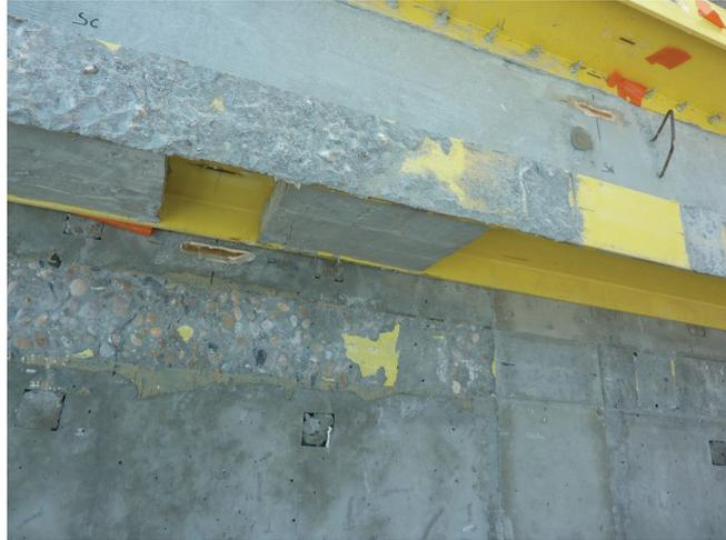
FIGURE 5.32: La rupture cohésive dans le béton de PB4
