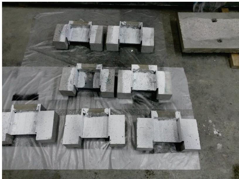
FIGURE 4.3: Le mouchetis sur les éprouvettes
