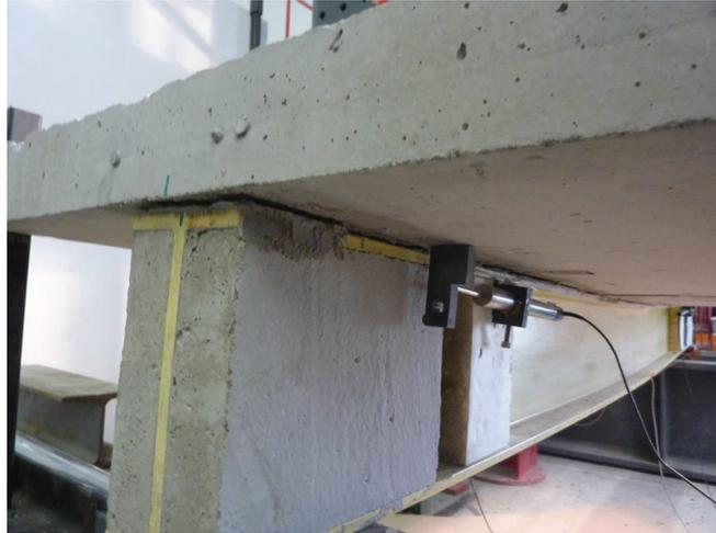
FIGURE 5.38: La ruine de PB6 par cisaillement de l'interface
