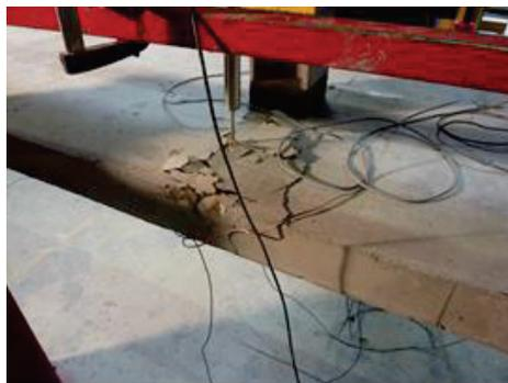
FIGURE 7.16: L'écrasement du béton de PB3 dans la zone centrale
