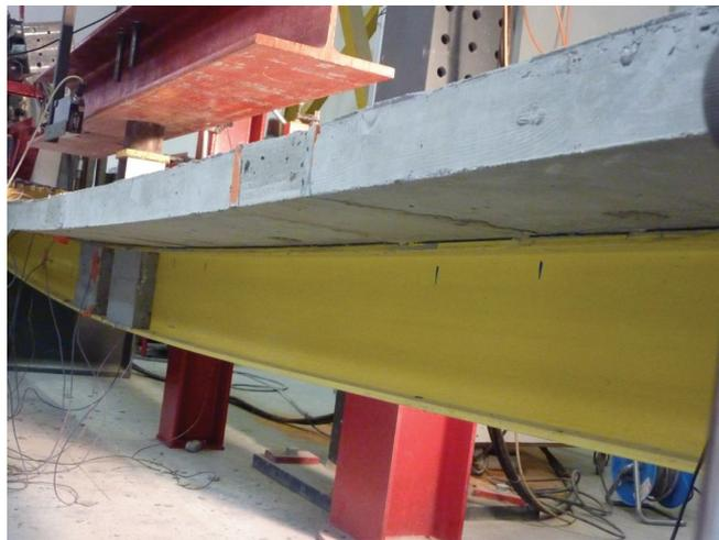
FIGURE 5.31: Le cisaillement de l'interface de PB4
