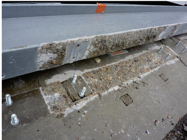
FIGURE 5.42: La ruine de PB7 par cisaillement de l'interface
