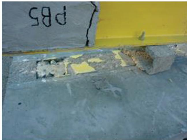
FIGURE 5.35: Le cisaillement des boulons visible après le démontage
