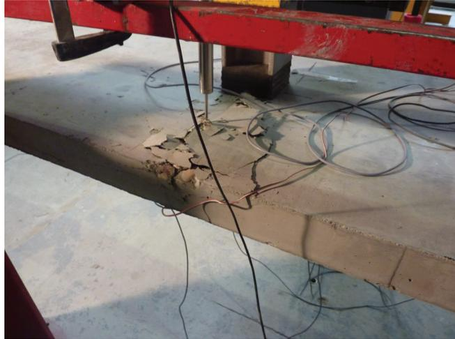
FIGURE 5.29: La ruine de PB3 en SC par écrasement du béton
