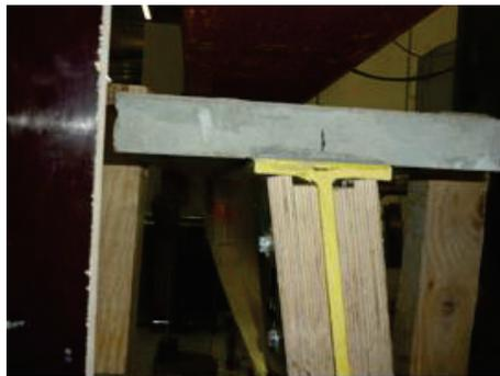
FIGURE 5.22: Le déversement d'appui dans PB1
