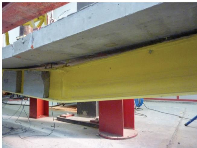
FIGURE 5.33: La ruine de PB5 par cisaillement de l'interface
