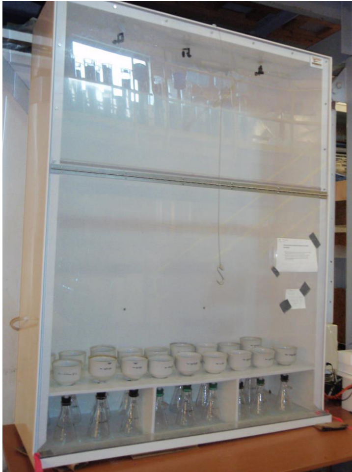
Figure 4.20 Mini-cellules d'altération en place dans la chambre contrôlée avec des cycles mouillage/séchage de 30s/4h
