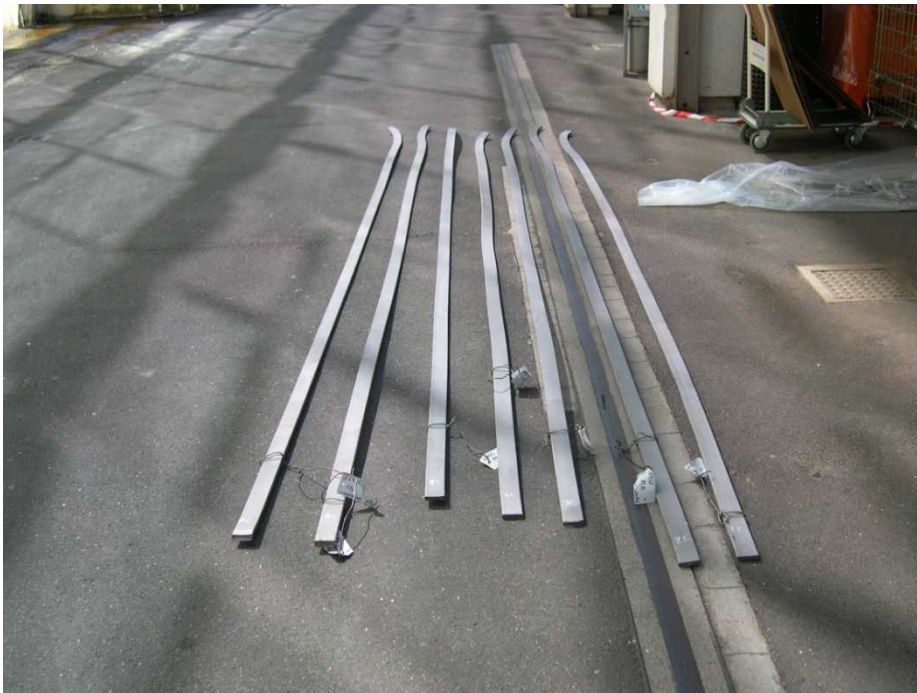
Figure 201 – Barreaux après extrusion.
