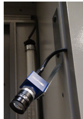
(b) Caméra sur support positionnée dans la machine-outil
