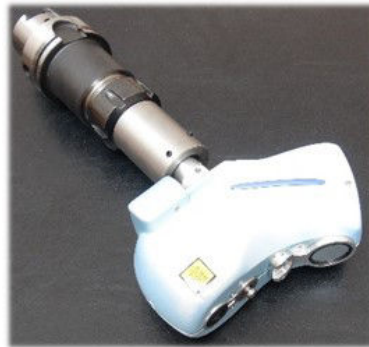
Figure 4.18 – Capteur laser Kréon monté dans un porte-outil
