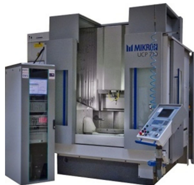
(a) Machine-outil 5 axes Mikron UCP710 et baie de mesure
