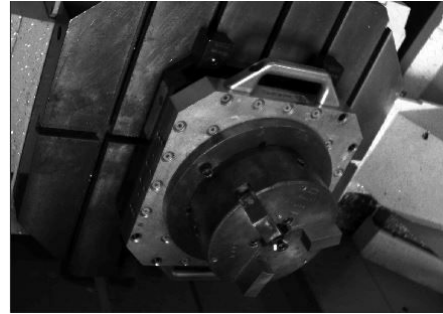
(b) Image du montage d'usinage utilisée pour la calibration In-situ
