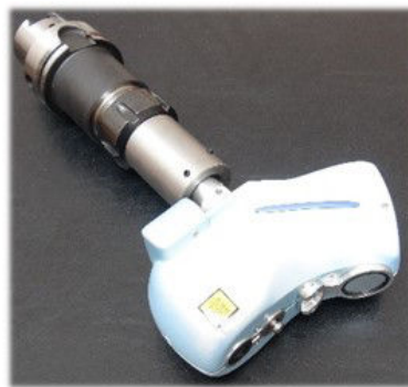
Figure 4.18 – Capteur laser Kréon monté dans un porte-outil
