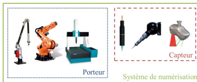
Figure 1.13 – Description d'un système de mesure/numérisation [Audfray et al., 2012]
