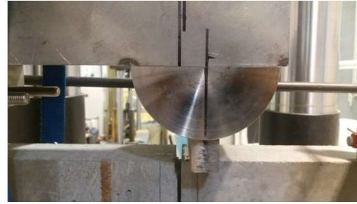
Appui fixe : utilisation d'une demi-lune
