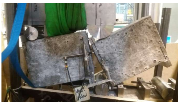
Figure 151: Rupture des éprouvettes en BFUP A
