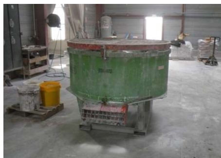
a) Malaxeur utilisé pour la fabrication du BFUP C
