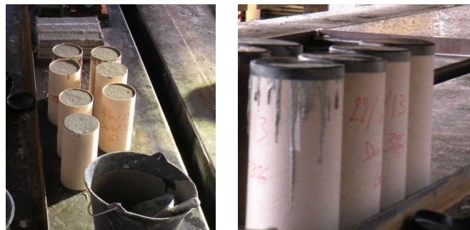
Figure 273: Fabrication des cylindres 11 x 22
