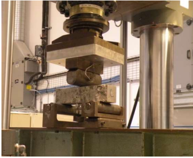
Vue du bâti au cours des essais de flexion 3 points
