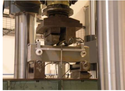
Vue du bâti au cours des essais de flexion 4 points
