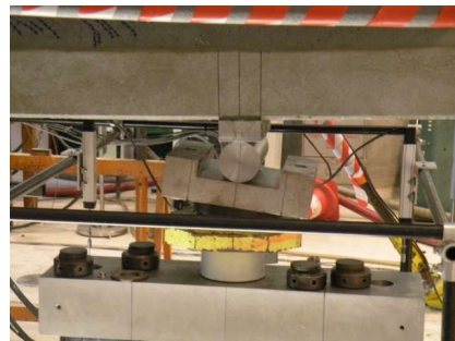
Appui inférieur à la fin de l'essai
