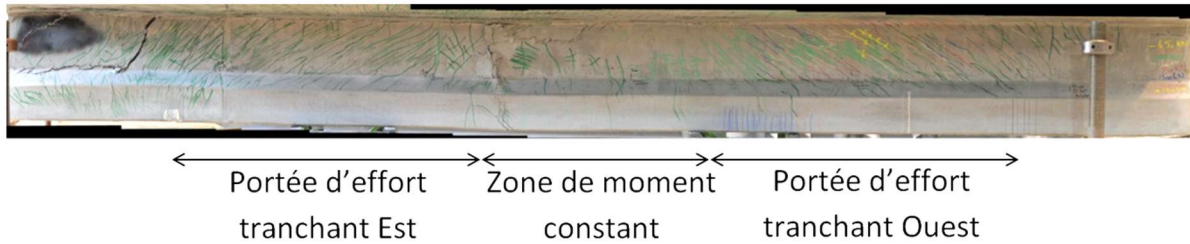
Figure 223: Relevé de fissure sur l'âme de la poutre BFUP B A
