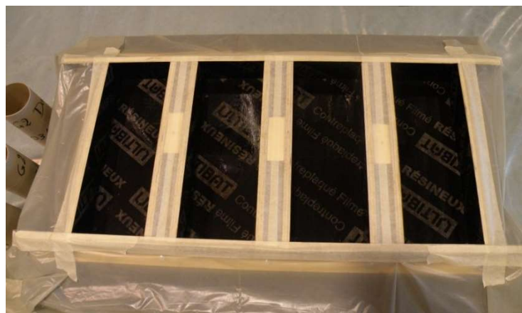
Figure 134: Coffrages utilisés pour fabriquer les corps d'épreuve de cisaillement
