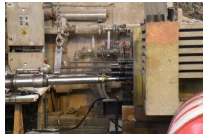
Vérin monotoron utilisé pour la tension finale
