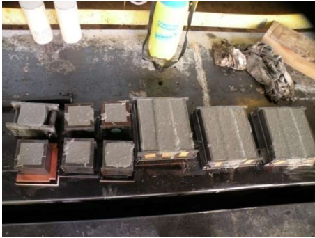
Fabrication des éprouvettes 7 x 7 x 28 cm
