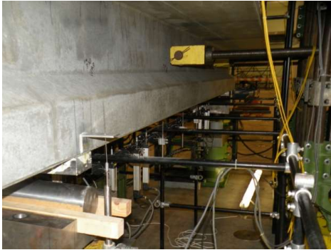
Mise en place des capteurs de déplacement sous la poutre
