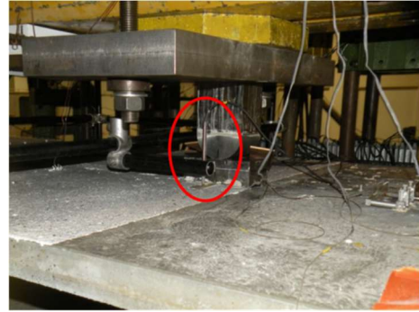
Mise en place des capteurs de déplacement au dessus de la poutre
