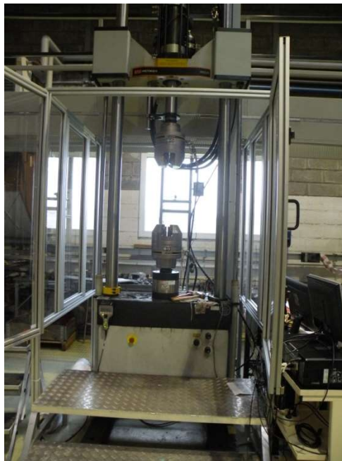
Figure 292: Presse utilisé pour la réalisation des essais de traction directe sur armatures
