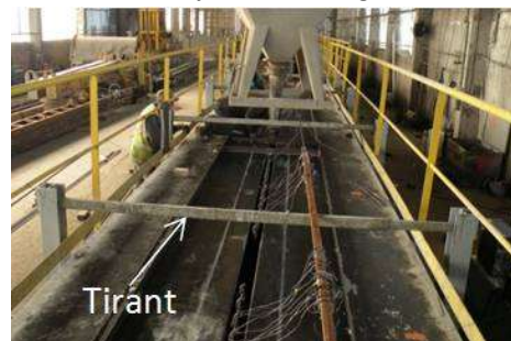
Tirants permettant de contrôler la géométrie
