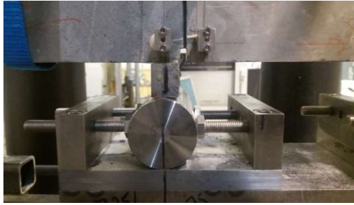
Appuis glissant : utilisation d'un rouleau
