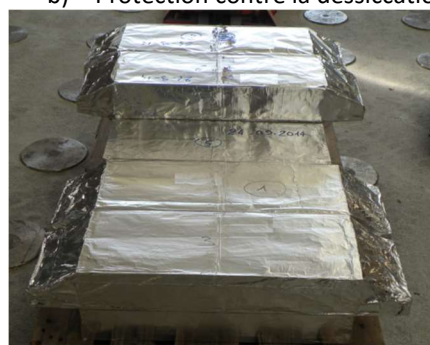
d) Protection contre la dessiccation avant stockage des corps d'épreuve
