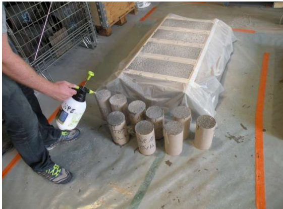
Application d'un produit de cure
