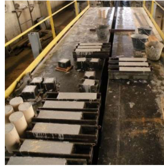
Fabrication des éprouvettes 10 x 10 x 40 cm
