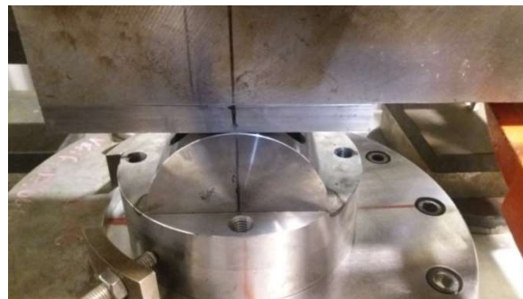
Figure 145: Appui entre le plateau de la presse et la traverse inférieure du bâti de sollicitation
