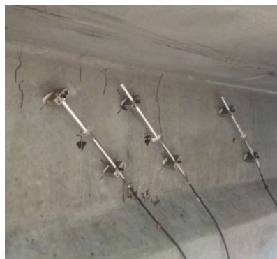
Figure 206: Suivi du comportement sous sollicitation de tranchant vertical
