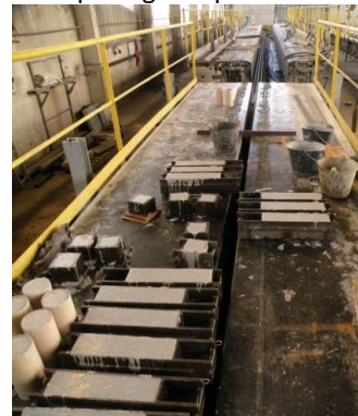
Remplissage des corps d'épreuve de caractérisation
