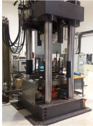
Figure 146: Presse utilisée pour réaliser les essais de cisaillement
