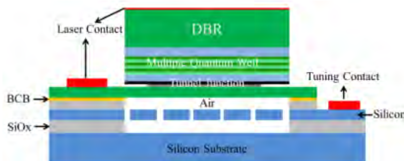
Figure 1.14 Principe d'un VCSEL accordable à base de MEMS HCG en SOI assemblé à un composant III-V par collage BCB [81]
