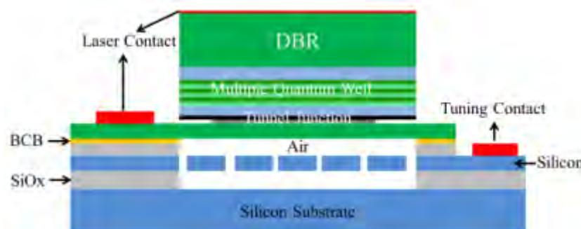
Figure 1.14 Principe d'un VCSEL accordable à base de MEMS HCG en SOI assemblé à un composant III-V par collage BCB [81]
