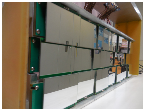
FIGURE 2.6 – Photographie du mur de siliciums utilisé. Les détecteurs se superposent sur leurs extrémités afin de limiter la surface des zones mortes. Photographie fournie par J. Goupil, Ganil, Caen.
