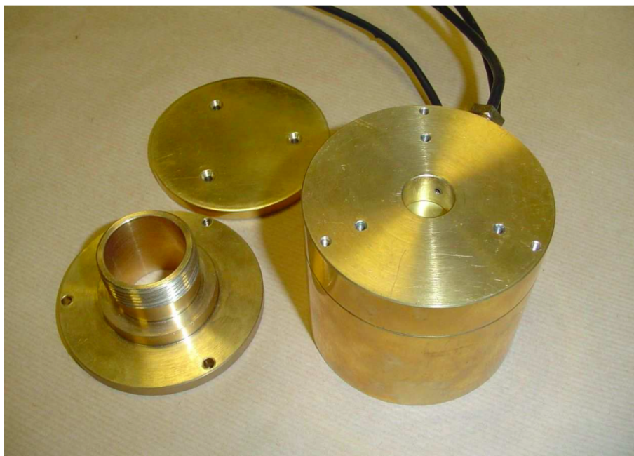
Figure A.4 Photo du système de mesure de l'Université du Maine. La partie principale est celle de droite. Les pièces de gauche sont des pièces d'adaptation. Figure empruntée à [Le Roux et al. , 2008].
