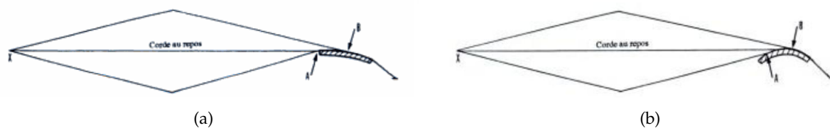
FIGURE A.1 – Schéma d'une corde en présence d'un chevalet courbe en position (a) fermée (b) ouverte. Issu de : (BERTRAND, 1992)
