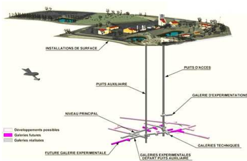
Fig 1-2. Installations de surface et souterraines autour des puits du laboratoire souterrain de Bure ( www.andra.fr )
